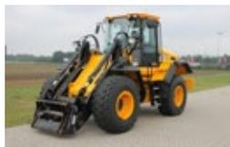
**JCB 437 HT AGRI** Bj. 2015, 127 kW, 173 PS, 5.480 Std., 6 Zylinder, 5-Gang-Powershift-Automatikgetriebe, Klima, SRS, Standard-HT-Hubgerüst, Volvo-Schnellwechsler, Bereifung: 20.5 R 25, **62.900 €**
