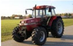
**Case IH MAXXUM 5140** Bj. 1997, 81 kW, 110 PS, 13.063 Std., 6 Zylinder, stufenlos, 40 km/h, 540/1.000 U/min, Heiz. u. Lüftungssystem, 2 x DW, Druckluft, FKH, FZW, EHR, **14.500 €**
