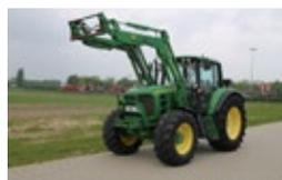
**John Deere 6530 PREMIUM** Bj. 2008, 103 kW, 140 PS, 8.862 Std., 6 Zylinder, 24+24, 40 km/h, 540/1000 U/min, Klima, 3 x DW, Druckluft, gef. Achse, FL John Deere 663 mit. 3.Funktion, **37.500 €**
