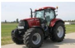
**Case IH PUMA CVX 160** Bj. 2015, 118 kW, 160 PS, 3.160 Std., 6 Zylinder, stufenlos, 50 km/h ECO, 540/540E/1.000 U/min, Klima, 3 x DW, Druckluft, K80, gef. Achse und Kabine, EHR, **63.500 €**
