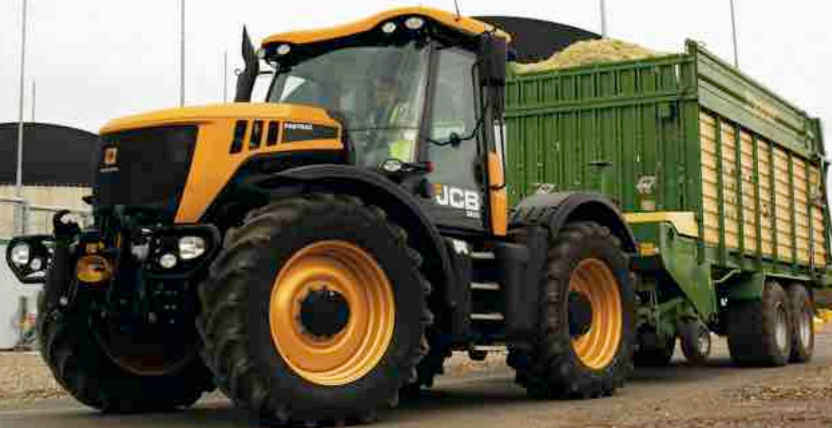
Seit dem Produktionsstart 1991 hat sich der JCB Fastrac stetig weiterentwickelt, um neuen Marktanforderungen gerecht zu werden – ohne jedoch die ursprünglichen Grundprinzipien zu vernachlässigen: Erstens die Vollfederung vorne und hinten, die der Fastrac nach wie vor als einziger Ackerschlepper bieten kann. Für maximalen Komfort und höchste Traktion ganz ohne zusätzliche Ballastierung. Zweitens die außenliegenden Scheibenbremsen, die den im Ölbad laufenden Systemen herkömmlicher Traktoren weit
