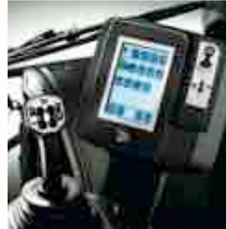
**Das Vorgewende-Management von JCB wurde entwickelt, um wertvolle Zeit zu sparen, indem es den Fahrer beim Handling von Traktor und Anbaugerät am Feldrand unterstützt. Auf Knopfdruck werden die Vorgewende-Manöver effizient ausgeführt, sodass sich der Fahrer auf die eigentlichen Arbeiten konzentrieren kann.**
