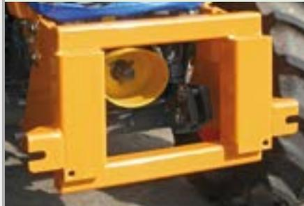
Zur mechanischen Aufnahme der frontseitig angebauten Mähgeräte wird eine Frontanbauplatte (Größe 3) an der Traktorfront angebaut. Diese Frontanbauplatte wird im Frontkraftheber aufgenommen, wobei die Unterlenkarme des Frontkrafthebers herausgenommen werden müssen. So entsteht eine leicht zugängliche und stabile Grundlage für den frontseitigen Mähgerätenbau.
