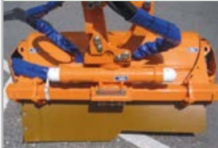
Der Verstellbereich beträgt 230 Grad und ist stufenlos über das Bedienpult steuerbar. Die Verstellung kann während des Arbeitsvorgangs erfolgen und ist variabel einstellbar.
