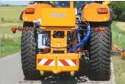
Zum Betrieb von frontseitig angebauten Mähgeräten über Heckzapfwelle wird ein Tragrahmen im Heckkraftheber für den hydraulischen Gräteantrieb angebaut. Über eine Gelenkwelle werden eine oder mehrere Hydraulikpumpen angetrieben. Der Tragrahmen dient gleichzeitig als Aufnahme für den Hydrauliktank, eventuelle Ballastgewichte und den Parkrahmen für den Ausleger in Transportstellung.
