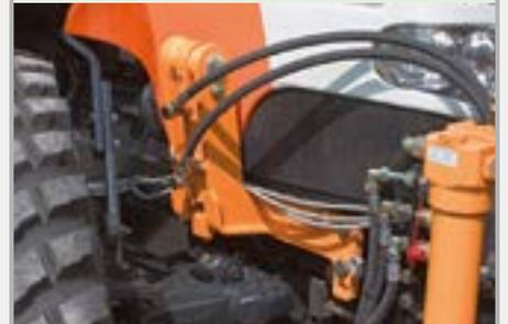
Um die entstehenden Torsionsmomente um die Fahrzeuglängsachse abfangen zu können, wird mit Hilfe eines Hydraulikzylinders eine zu- und abschaltbare Abstützung auf den Achskörper des Traktors eingebaut. Die Ölversorgung der Abstützung erfolgt über die Traktorhydraulik. Je nach Einsatzzweck kann eine einseitige oder beidseitige Abstützung auf dem Achskörper erfolgen.
