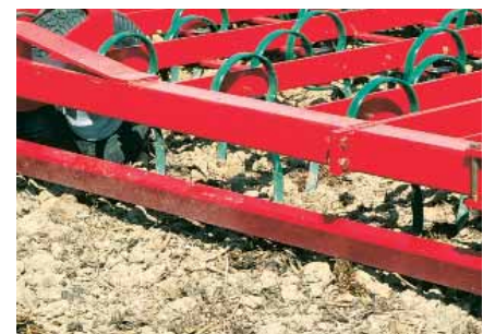
Die Planierschiene kann in Höhe und Winkel verstellt werden und ist dank der Non-stop Einrichtung vor eventuellen Hindernissen geschützt.
