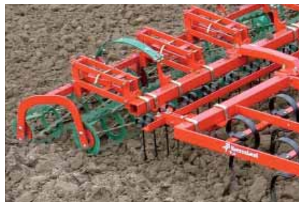
Die Krümmerwalzen sind an einem Parallelogramm aufgehängt. Die Walzen haben 2 verschiedene Durchmesser, vorne größer und hinter kleiner, wodurch die Krümelung verbessert wird.
