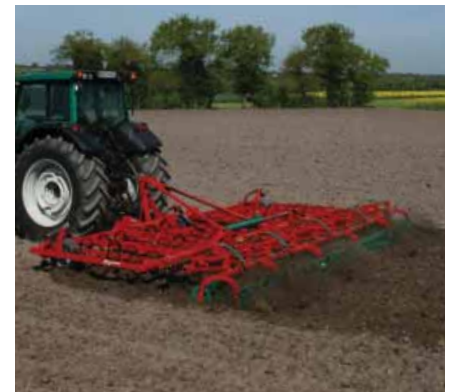
Die Krümmerwalzen sind an einem Parallelogramm aufgehängt. Die Walzen haben 2 verschiedene Durchmesser, vorne größer und hinter kleiner, wodurch die Krümelung verbessert wird.
