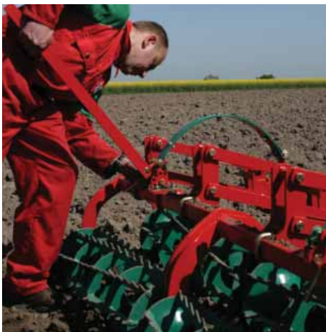
Der Druck auf die Krümmerwalzen kann mithilfe eines mitgelieferten Spanners eingestellt werden.
