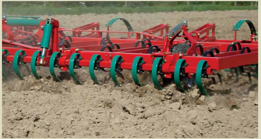
Die Planierschiene kann in Höhe und Arbeitswinkel verstellt werden; mit Hilfe einer „Nonstop“-Überlastsicherung kann die Schiene beim Auftreffen auf ein Hindernis ausweichen.
