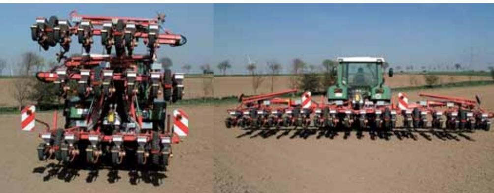
MONOPILL SE, 9 Meter, 18 Reihen mit parallel-hydraulischer Klappung in Transport- und Arbeitsposition.
