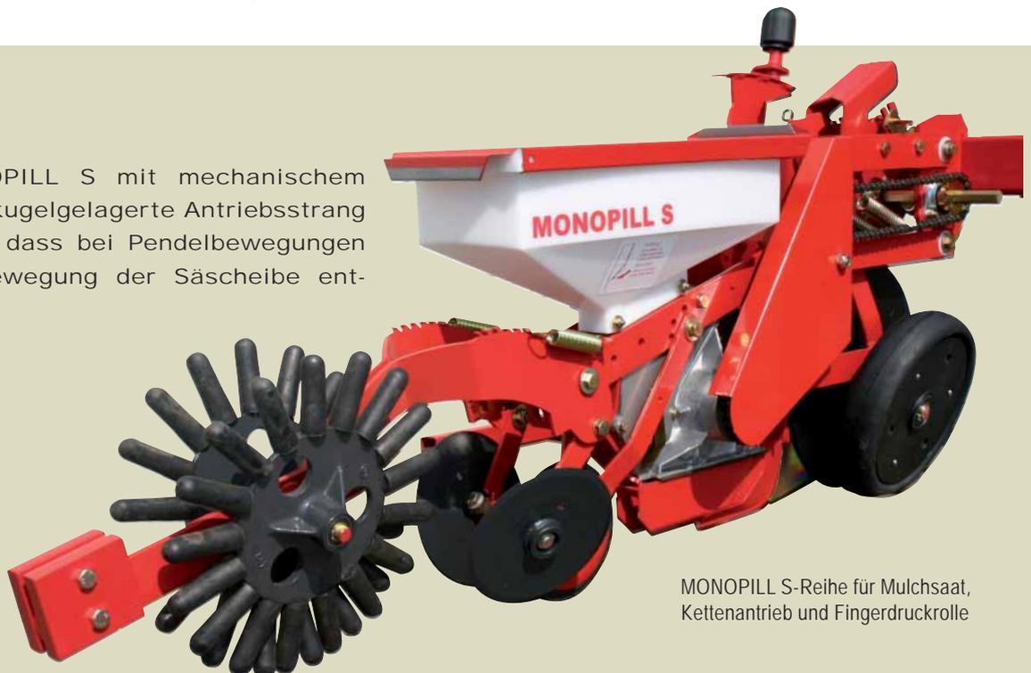
MONOPILL S-Reihe für Mulchsaat, Kettenantrieb und Fingerdruckrolle
