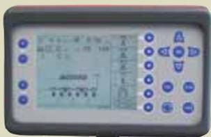
Mit Visus (Opto Electronic Control) in der Schlepperkabine kann der Fahrer die einwandfreie Funktion der Maschine ständig überwachen.
