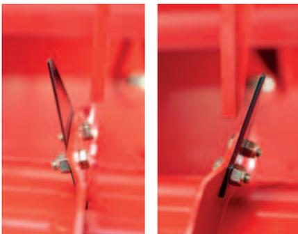
Ein patentiertes System - Die Messer sind an schräg stehenden Ringen befestigt, so dass sie wechselseitig an den Zähnen eines feststehenden Schneidkamms entlang streichen.
