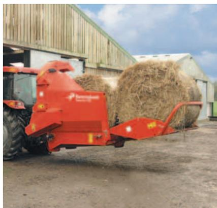
Die besondere Konstruktion der Heckklappe macht es möglich, einen zusätzlichen Rundballen mitzuführen.
