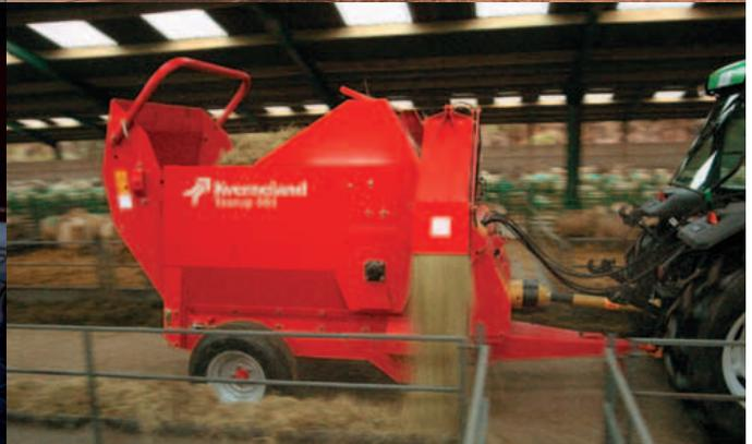
Der Kverneland Taarup 853 und 856 kann werksseitig mit dem Standard- oder dem Schwanenhalsauswurf ausgestattet werden. Beide sind sowohl zum Einstreuen als auch zum Füttern geeignet. Um die volle Auswurfleistung ausnutzen zu können, ist der Auswurfurm direkt über dem Schwungrad angebracht.
