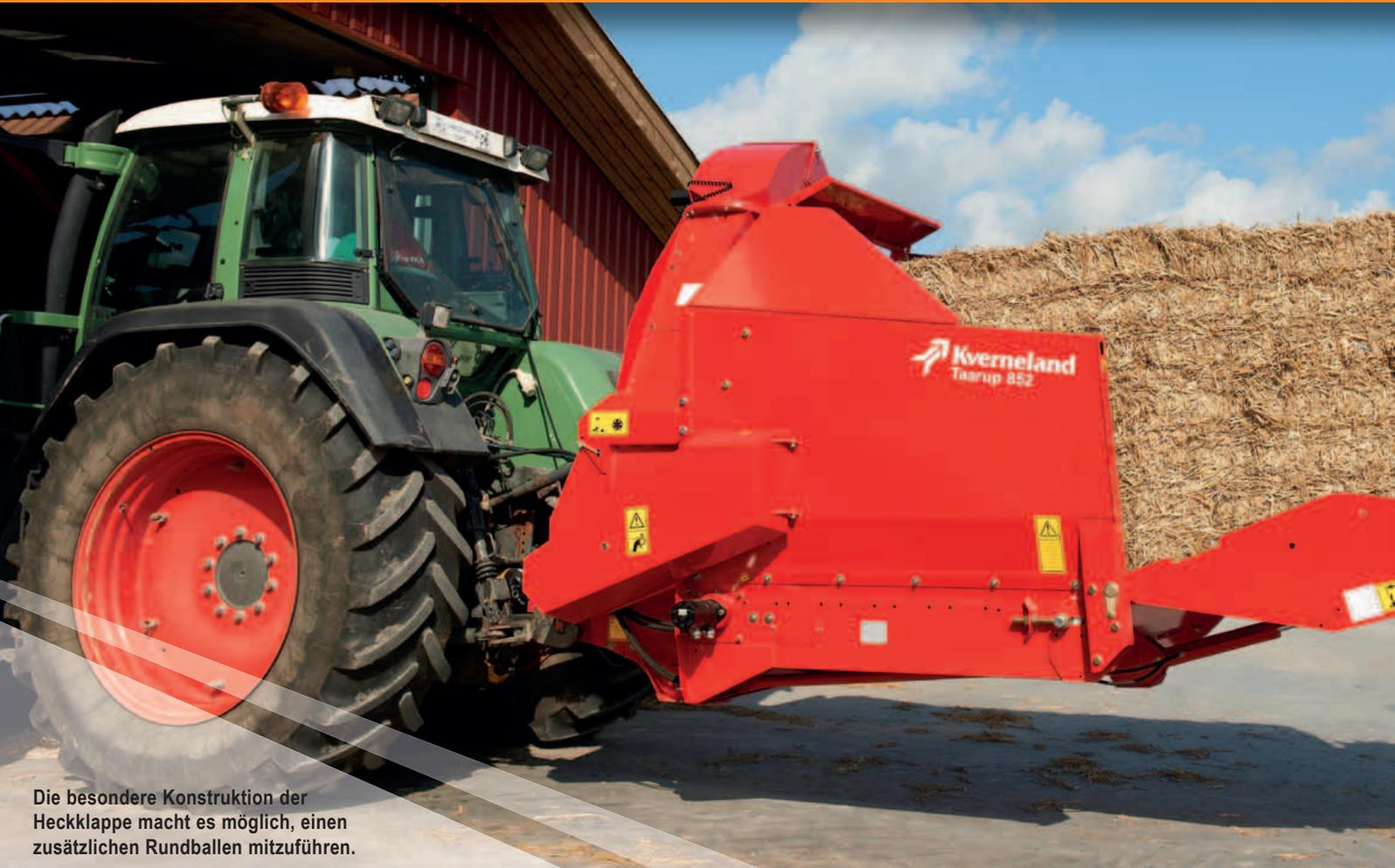
Die besondere Konstruktion der Heckklappe macht es möglich, einen zusätzlichen Rundballen mitzuführen.
