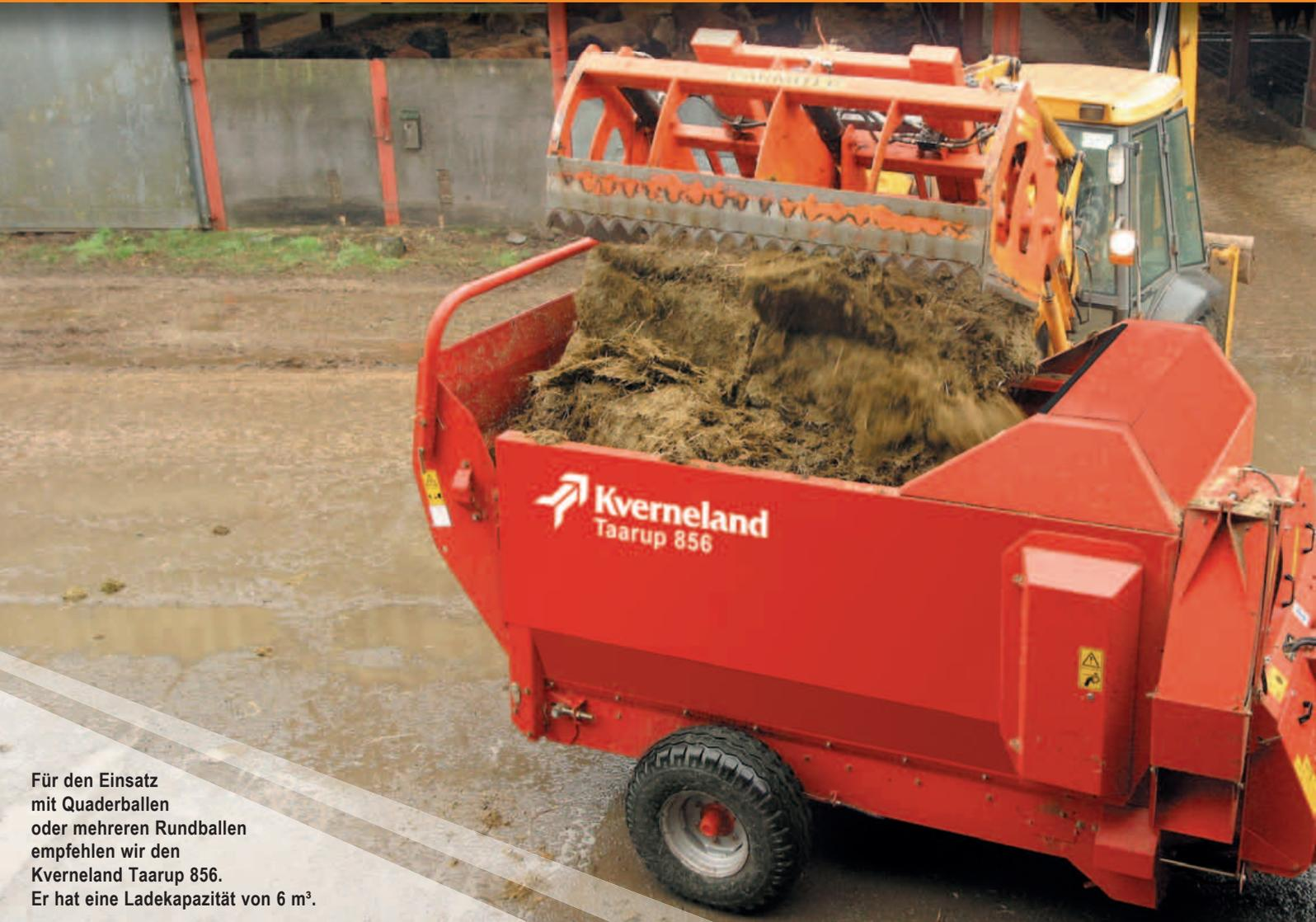
Für den Einsatz mit Quaderballen oder mehreren Rundballen empfehlen wir den Kverneland Taarup 856. Er hat eine Ladekapazität von 6 m<sup>3</sup>.
