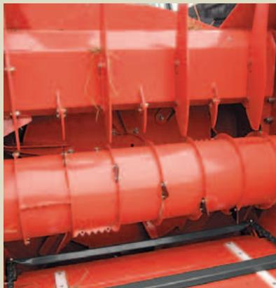
Die Konfiguration von Trommel und Schneidkamm ist speziell auf die Verarbeitung von Stroh ausgerichtet.
