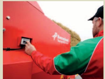
Die Fernbedienung der 853 PRO und 856 PRO erleichtert den Ladevorgang, da der Fahrer dies direkt vor Ort betätigen kann und nicht in die Schlepperkabine gehen muss.
