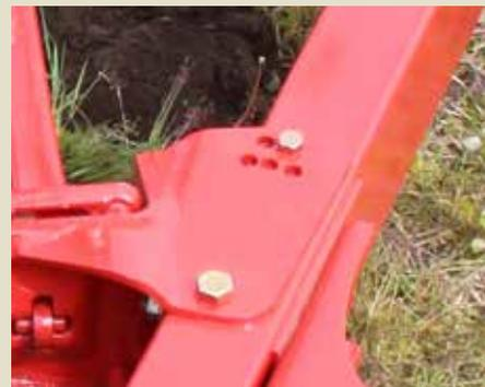
Manuelle Schnittbreitenverstellung in 5 cm Schritten
