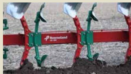
Grindel mit Scherbolzensicherung
