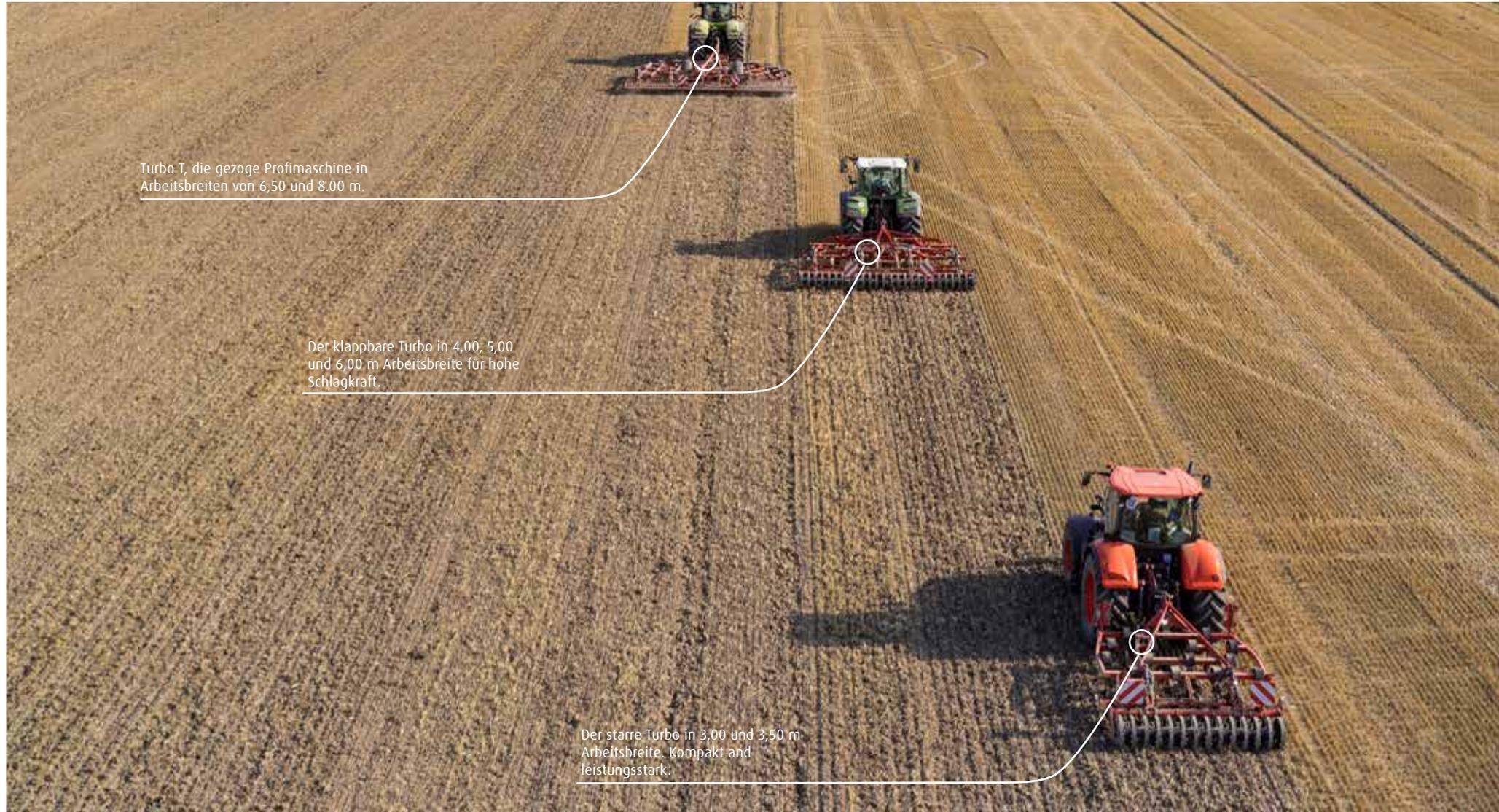
Turbo T, die gezogene Profimaschine in Arbeitsbreiten von 6,50 und 8,00 m.
