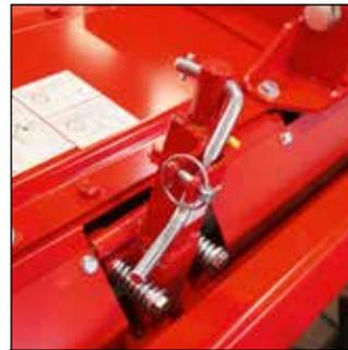
Die gefederte, stufenlos einstellbare Planierschiene erzeugt eine ebene Oberfläche und intensive Zerkleinerung.
