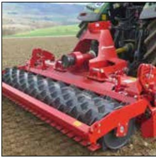
Anbaumöglichkeiten für Rohrstab-, Zahnpacker-, Cracker- oder Flexlinewalze.
