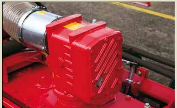
Alle klappbaren Kverneland Kreiseleggen sind mit einem Wechselgetriebe ausgestattet. Mit einer Überlastsicherung von 1800 Nm bis 2500 Nm sichert dieses einen Endantrieb mit Schleppern bis zu 350 PS. Die Zinkengeschwindigkeit zwischen den Modellen F20, F30 und F35 variiert von 246 bis 450 U/min bei einer Zapfwellendrehzahl von 1000 U/min.
