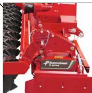
Die Tiefeneinstellung ist nahe am Turm positioniert, um die Kräfteinwirkung auf die gesamte Konstruktion zu minimieren. Die Bauart erlaubt die Verwendung aller Kverneland Walzentypen.
