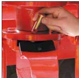
Die Schnellwechselzinken sind mit einem Bolzen und Klappstecker gesichert. Alle Zinken können in kürzester Zeit ohne Werkzeug gewechselt werden.
