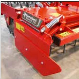
Parallelogramm geführte Seitenplatten mit Überlastsicherung gewährleisten eine gleichmäßige Einebnung, ohne Dämme zu hinterlassen.
