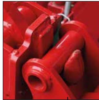
Um Kreiseleggen (H-Serie und NG-S), die mit einer Sämaschine aufgesattelt sind auch im Soloeinsatz nutzen zu können, müssen diese mit der "Euro-Connection" ausgerüstet sein. Mittels der Fanghaken, vergleichbar wie beim Frontlader, kann die Scharfschiene jederzeit ab- und angekuppelt werden.
