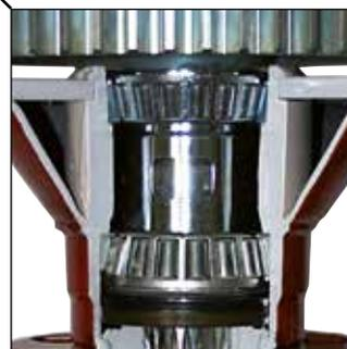
Die robuste Welle und zwei hochleistungsfähige Kegelrollenlager mit großem Freiraum ermöglichen störungsfreie Funktion und lange Einsatzsicherheit.
