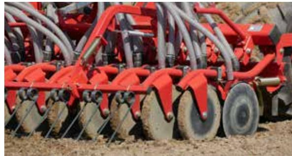
Dank des extrem schlanken Designs des CD-Säschares wird nur wenig Boden bewegt. Daher wird nur wenig Schardruck benötigt, um die gewünschte Sätiefe zu erreichen. So kann, falls erforderlich, mehr des Schardrucks (bis 100 kg) auf die Andruckrolle gegeben werden. Das Ergebnis ist eine sehr gleichmäßige Saatgutablage. Zur gleichzeitigen Ausbringung von zwei Saatgütern bzw. von Saatgut und Dünger steht das CD-Doppelsäschar mit zweitem Auslauf zur Verfügung.
