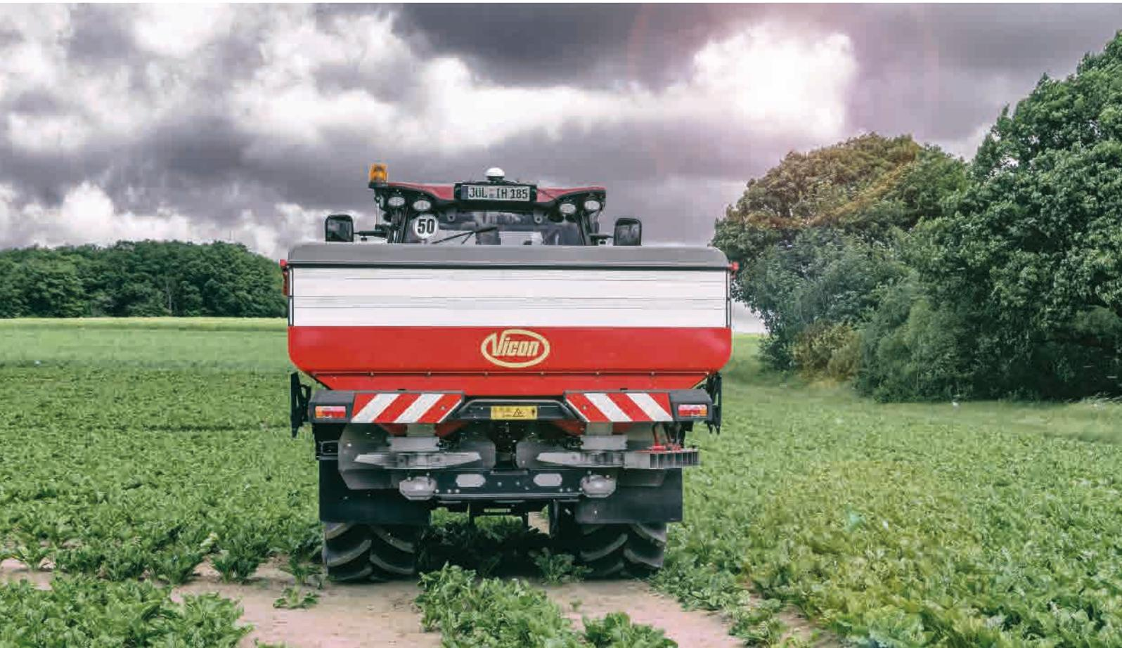
**Eine Grenzstreueinrichtung wird verwendet, um das Streubild von oder zu der Grenze eines Feldes hin zu optimieren, mit dem Ergebnis einer maximalen Verteilung innerhalb der Feldgrenzen, um einen optimalen Bestand zu gewährleisten, sowie einem minimalen Verlust ausserhalb der Feldgrenzen, um die Umweltbelastung zu minimieren.**
