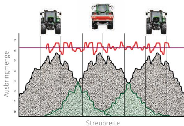
Der Variationskoeffizient (CV) eines optimalen Streubildes sollte unter 10% liegen. Dies ist nur in einer Situation ohne Über- oder Unterdosierung und eine perfekte Überlappung des Streubildes möglich.
