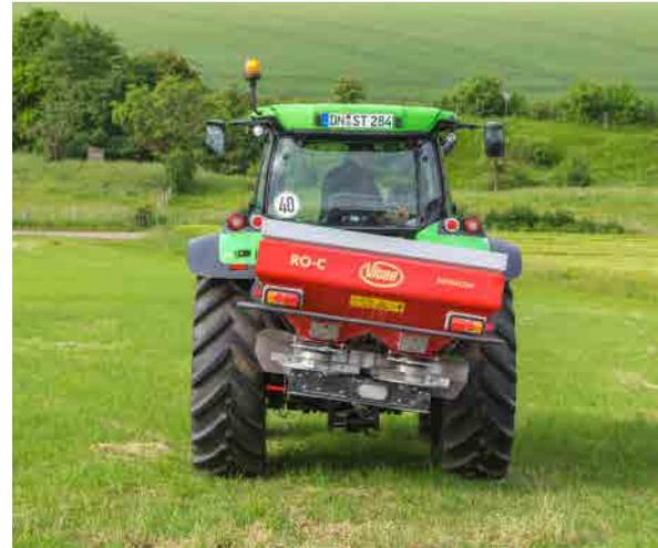
Grenzstreuen mit hydraulischem Schrägstellzylinder
