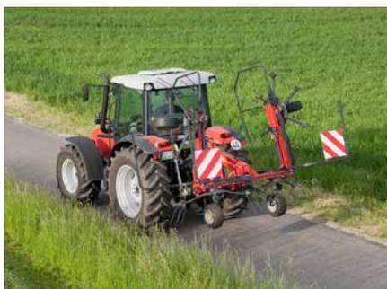
Die Kreiselzettwender werden hydraulisch von Arbeits- in Transportposition und umgekehrt geklappt.
