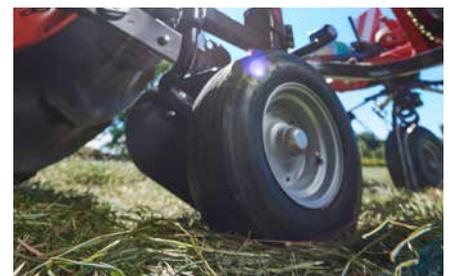
Optional können die Zettwender mit einem Stützrad ausgerüstet werden. Dies entlastet den Fahrer, da die Arbeitshöhe einmal über das Stützrad eingestellt wird.
