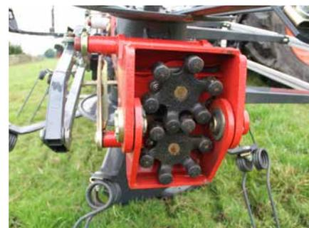
Die neue XL-Version der HexaLink Fingerkupplung sorgt für eine zuverlässige Kraftübertragung und ermöglicht eine 180° Klappung der Rotoren.
