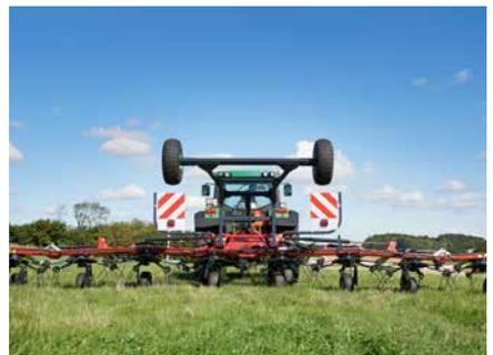
Die Klappung von Transport- in Arbeitsstellung erfolgt hydraulisch.
