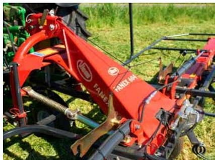
Die starke Konstruktion des V-förmigen Hauptrahmens sorgt während des Zettens für eine hohe Stabilität und erlaubt eine hohe Transportgeschwindigkeit.
