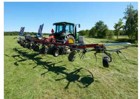
Alle Fanex Zettwender die im Dreipunktbau gefahren werden können mit dem optionalen hydraulischen Vorgewendeseit ausgerüstet werden.\*
