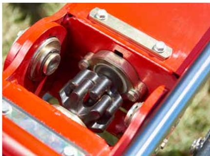
180° Klappung der äußeren Rotoren für den
