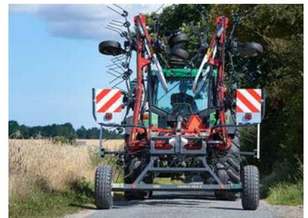
Das Transportfahrwerk ist mit einer groß dimensionierten Bereifung 10.0/75 – 15.3“ ausgestattet.
