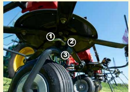
Durch die Einstellung des richtigen Streuwinkels wird die Streuung verbessert und der Trocknungsprozess beschleunigt. Ein steiler Winkel für aggressivere Ablage oder ein flacher Winkel für schonende Bearbeitung der Futters.
