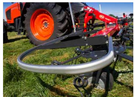
Die neuen Schutzbügel sind aus Aluminium gefertigt. Sie überzeugen durch ein geringes Gewicht bei sehr hoher Belastbarkeit.
