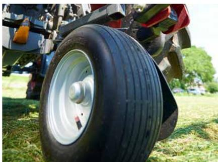
Alle Wender können optional mit einem Stützrad ausgestattet werden. Dies entlastet gerade bei langen Arbeitstagen den Fahrer und sorgt immer für gleichbleibende Arbeitsqualität.
