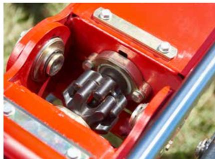
Die Vicon HexaLink-Kupplung an den äußeren Kreislern erlauben eine kompakte Transportklappung beim Fanex 764 und 904.
