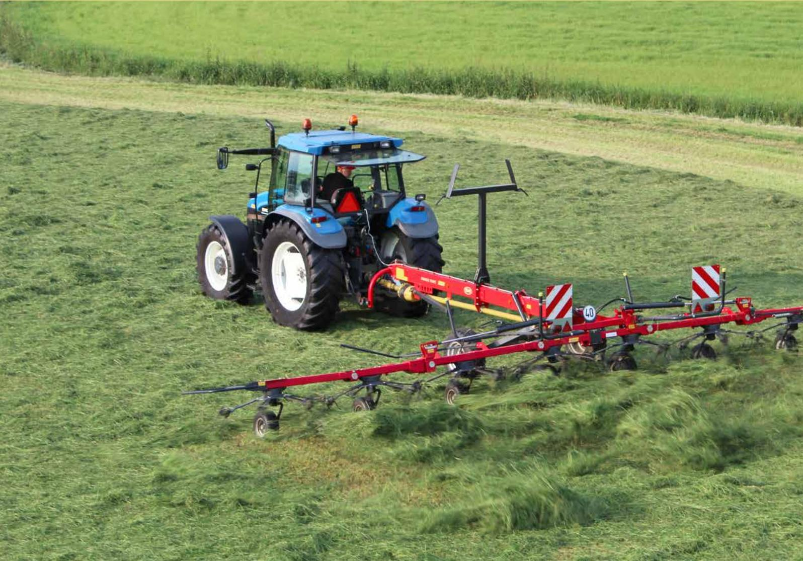
Fanex 1103C mit 8 Rotoren und einer Arbeitsbreite von 11,00 m.
