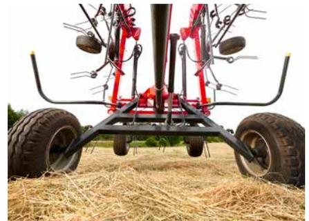
Breite Transportachse für sicheren Straßentransport.
