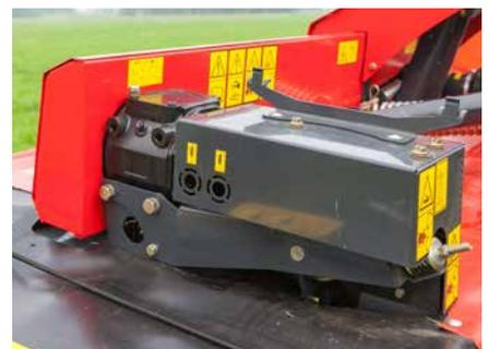
Die Schnecke wird über ein kleines Getriebe angetrieben. Der zusätzliche Leistungsbedarf beträgt lediglich 5 PS.
