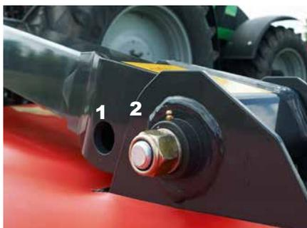
Zwei Anbaupunkte – so kann das Heckmähwerk an das Frontmähwerk angepasst werden.
