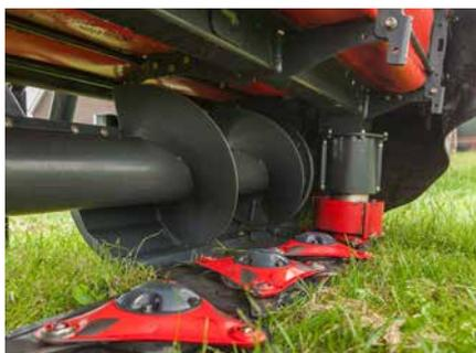
Aktiv angetriebene Schwadzusammenführung für ein perfektes Schwad.
