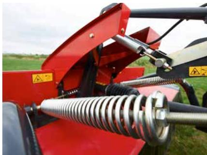
Zwei Entlastungsfedern sorgen für perfekte Boden Anpassung.
