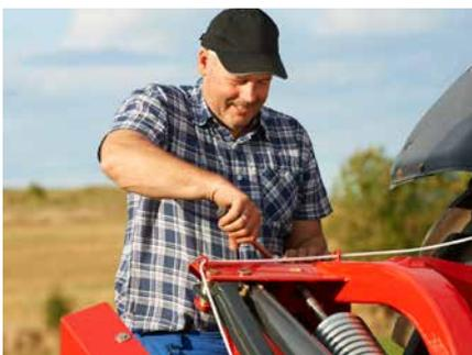
Einfach einstellbare Entlastungsfedern.
