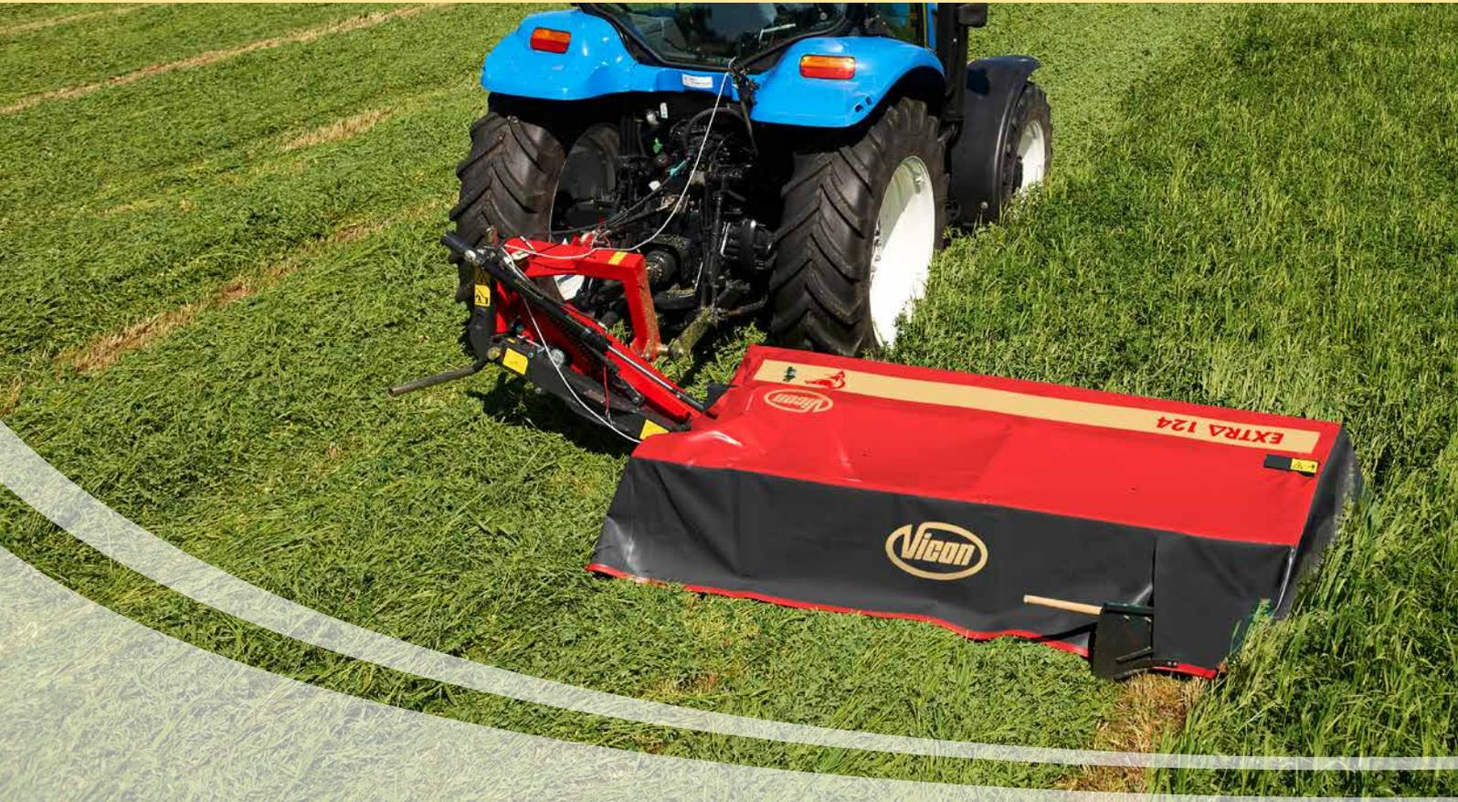
Die EXTRA 100 Baureihe ist mit dem geschweißten Mähbalken ausgestattet. Dieser Mähbalken überzeugt durch seine Laufruhe und seine sehr gute Arbeitsqualität. Er besteht aus zwei ineinander gelegten C-Profilen die miteinander verschweißt werden.
