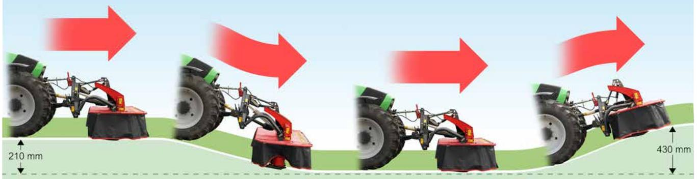
Das Mähwerk kann sich optimal den Bodenkonturen anpassen. Es kann 430 mm nach oben und 210 mm nach unten arbeiten.
