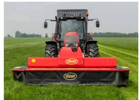
Der Einsatz mit reduzierter Drehzahl ist möglich beim EXTRA 332XF. Durch Wechsel der Riemenscheiben sind 750 U/min möglich.
