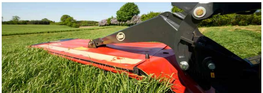
Die Mittenaufhängung ermöglicht schnelle und präzise Boden Anpassung.
