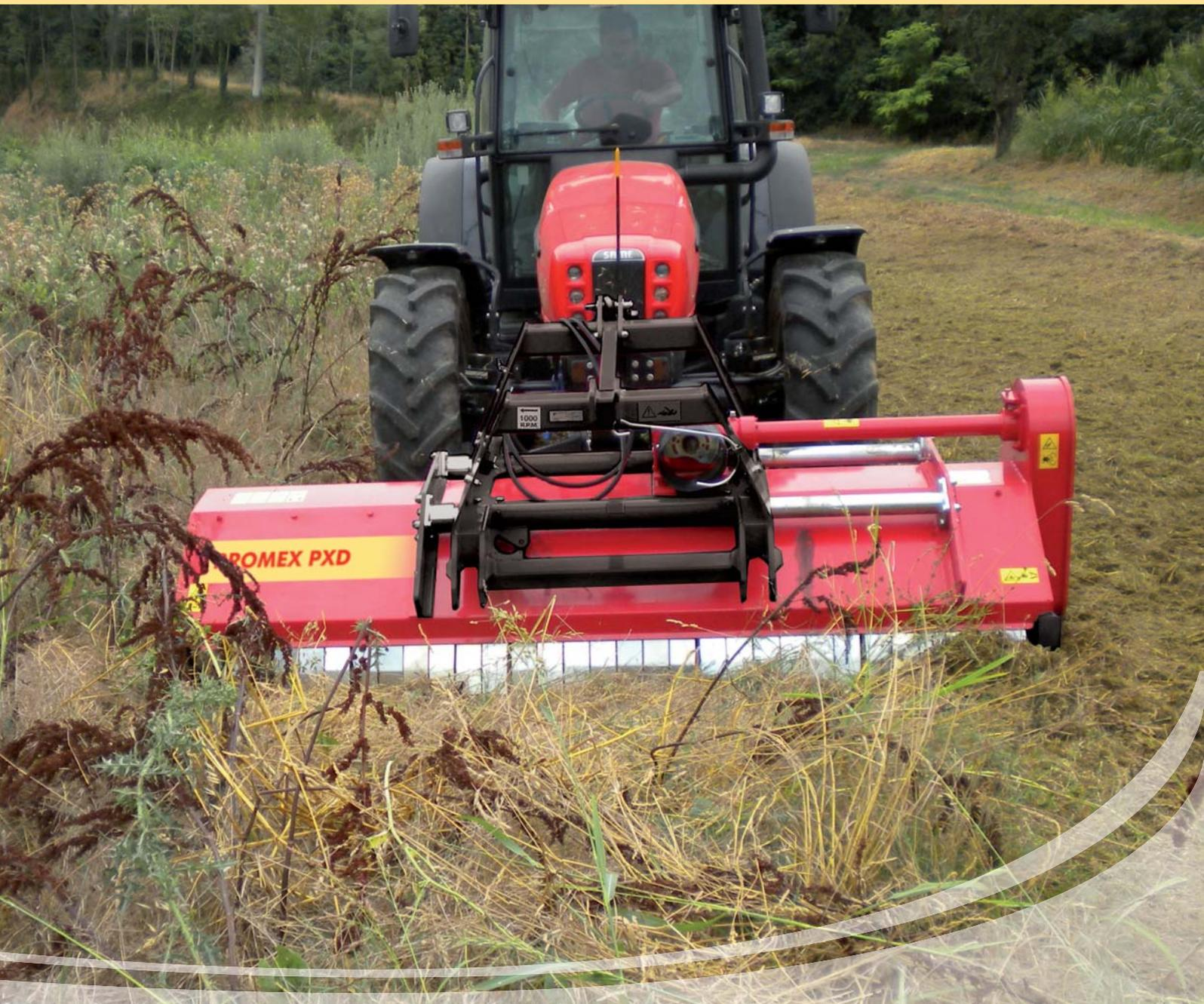
Der doppelte Anbaubock ermöglicht sowohl Front- als auch Heckenbau des PXD. Die serienmäßige hydraulische Verschiebung von bis zu 52 cm macht den PXD zu einem effizient und universell einsetzbaren Gerät. Die in den Anbaubock integrierten Gleitrohre der Seitenverschiebung sind mit verschleißarmen und wartungsfreien Kunststoffblöcken versehen, so dass auftretende Kräfte auf den Schlepper übertragen werden.
