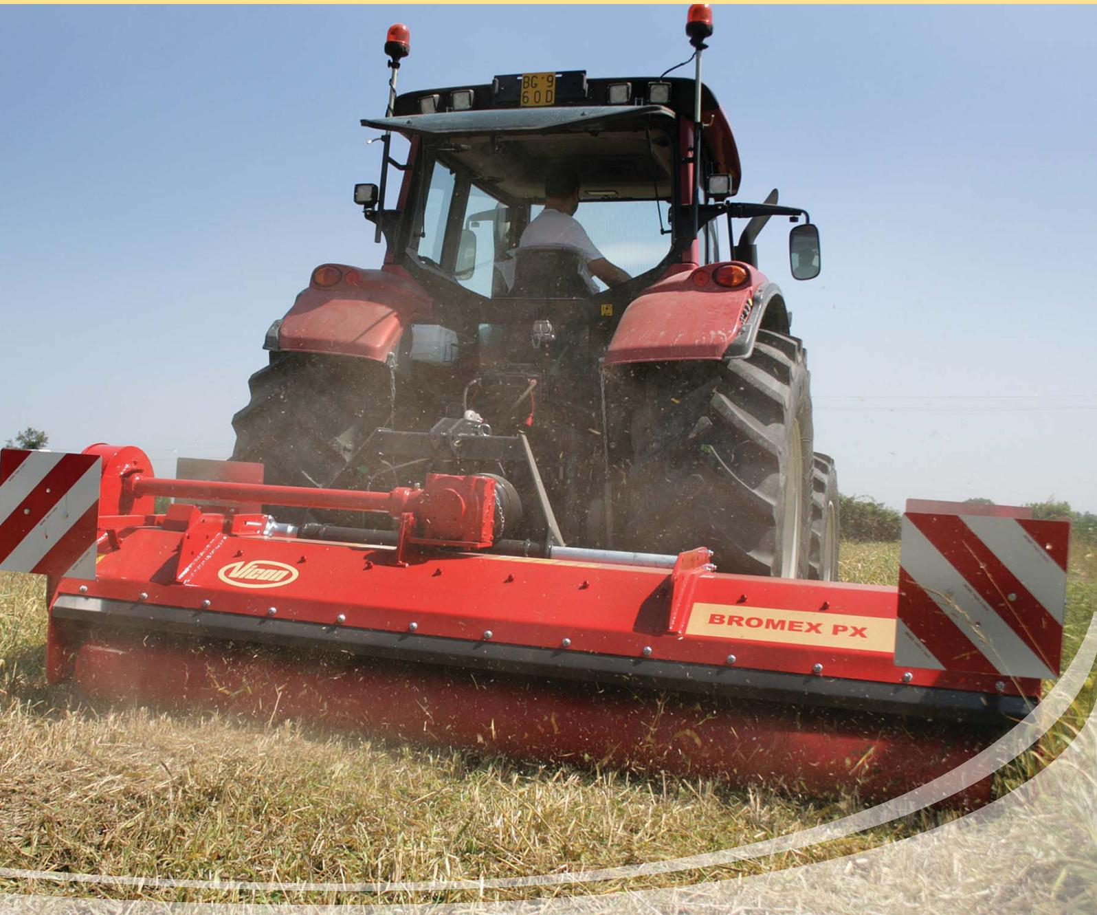
Der Bromex PX ist ein vielseitiger Mulcher für Gras, Weideland, unbewirtschaftete Flächen und Stoppelland. Die hydraulische Seitenverschiebung des PX ermöglicht das Mulchen von Feldrändern, Obstplantagen und Straßenrändern. Hammerschlegel und universelle Y-Schlegel mit kurzen Lüftungsmessern sorgen für ein perfektes Mulchergebnis in allen Bedingungen.
