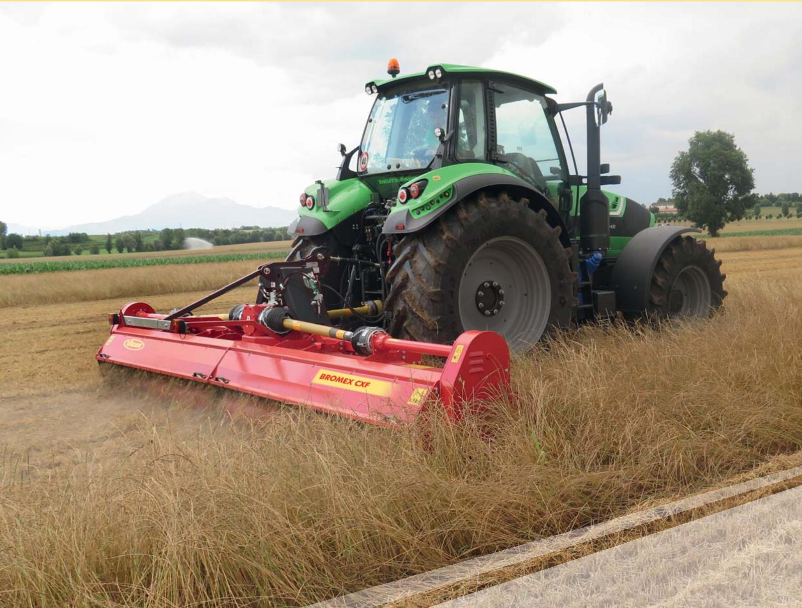
Der klappbare Bromex CXF ist in 5,60 m und 6,40 m Arbeitsbreite erhältlich und wird von Schleppern bis 260 PS gezogen.
