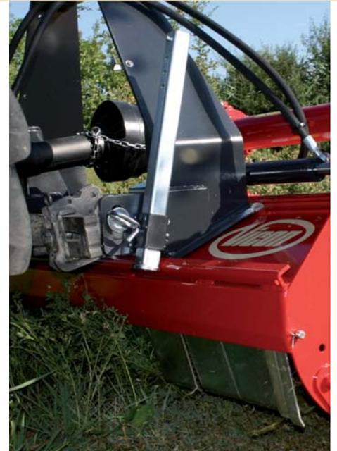
Für Traktoren von bis zu 80 PS. Zapfwellenschwindigkeit 540 oder 1000 U/min durch Wechsel der Riemenscheiben. Sicherung durch integrierten Freilauf.
