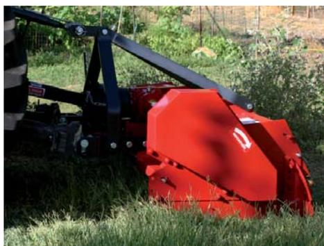
Die Anhängung ist mit einem Langloch versehen. Auftretende Kräfte werden durch die nach hinten laufende Abstützung direkt in der Rahmenkonstruktion abgefangen.
