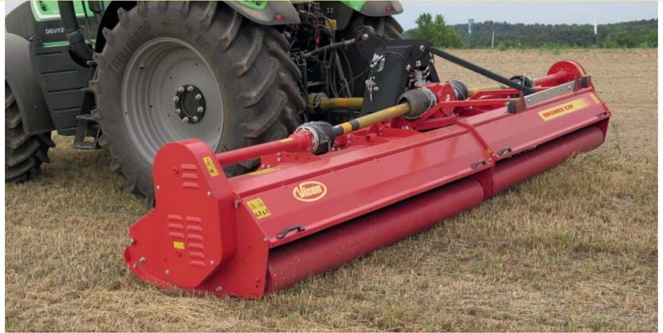
Arbeitsbreiten von 5,60 m bis 6,40 m. Die Walze (Ø 245 mm) läuft sehr nah am Rahmenprofil, um einen Selbstreinigungseffekt zu erzielen.
