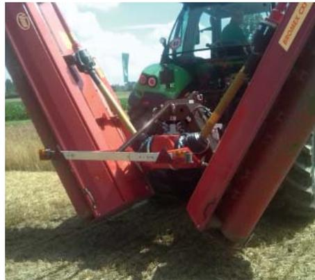
Der hydraulisch klappbare Rahmen stammt aus der Vicon Kreiselfegenfamilie; robust und verlässlich auch unter harten Bedingungen. Die hydraulische Sperre ist Standard.
