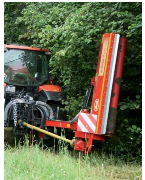
Robust und geschützt. Hauptrahmen und Parallelogramm werden entsprechend der FEM-Kalkulation und dem Stresstest auf dem Schüttelprüfstand in Klepp (Pflugproduktion Norwegen) ausgiebig getestet, um ein zuverlässiges und sicheres Arbeiten zu gewährleisten. Getriebe und Kraftübertragung sind gegen Überlastung geschützt.
