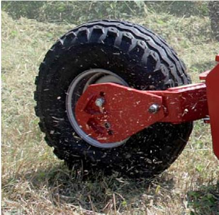
Schwenkbare Räder (10/8.0 x 12.8 ply) als Standardausrüstung sorgen für zusätzliche Stabilität und eine konstante Tiefenführung des Bromex CZ.
