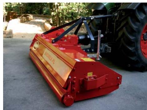
Zum Schutz von Bäumen und Ästen in Obstplantagen, steigt das Gehäuse des Mulchers von vorne nach hinten an. Äste können somit leichter über den Vicon PL gleiten.
