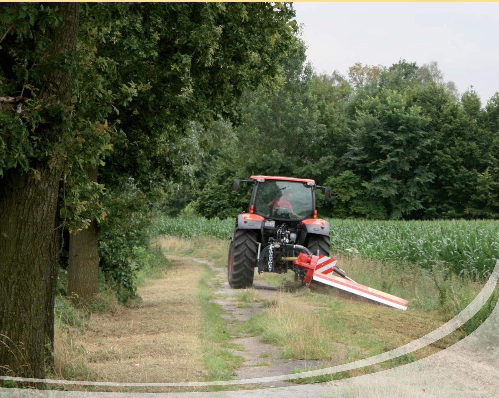
Der große Bruder des Bromex M überzeugt durch eine höhere, maximale Antriebsleistung (150 PS), durch Arbeitsbreiten von 200 cm, 230 cm und 250 cm und die größere Seitenverschiebung von bis zu 1200 mm. Kombiniert mit einem Frontmulcher (Vicon Bromex PF oder PXD) stellt er eine flexible und leistungsstarke Einheit dar.
