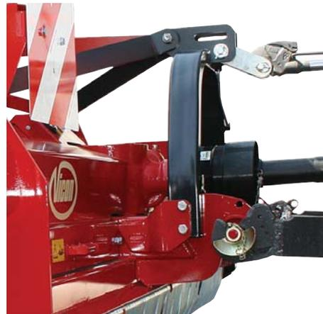
Die Halbautomatische Anhängung (Kat III) ermöglicht ein schnelles Ankuppeln des CZ. Zusätzlich sorgt das Langloch im oberen Koppelpunkt für eine gleichmäßige Tiefenführung ohne zusätzliche Kräfteinwirkung auf den Anbauturm.
