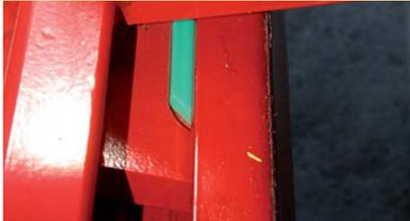
Spezielle Führungsbuchsen aus Nylon sichern einen ruhigen Lauf ohne zusätzliche Schmierung oder Wartung.
