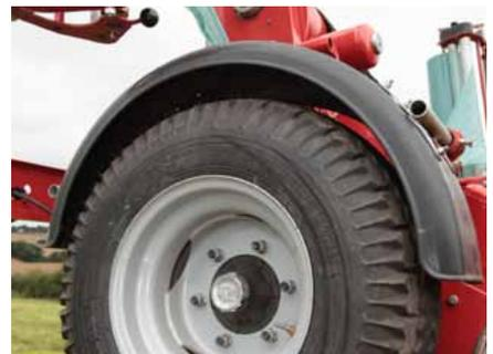
Die Kotflügel reduzieren die Verschmutzung an den Vorstreckern und Folienrollen.
