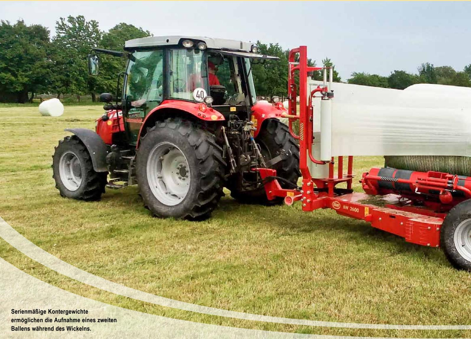
Serienmäßige Kontergewichte ermöglichen die Aufnahme eines zweiten Ballens während des Wickelns.
