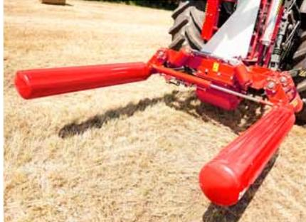
Zwei angetriebene Walzen sorgen für ein gleichmäßiges Drehen des Ballens.
