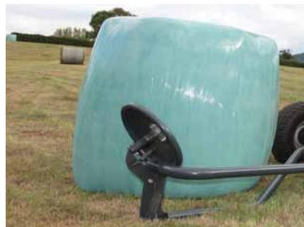
Der Vicon BW 2850 kann optional mit einem Ballendreher ausgerüstet werden, der die Ballen sanft auf der Stirnseite ablegt.
