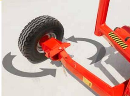
Für eine sichere Ballenaufnahme wird das rechte Rad nach außen gedreht.
