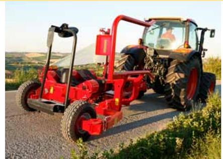
Für eine schmale Transportbreite wird das rechte Rad einfach nach innen gedreht.
