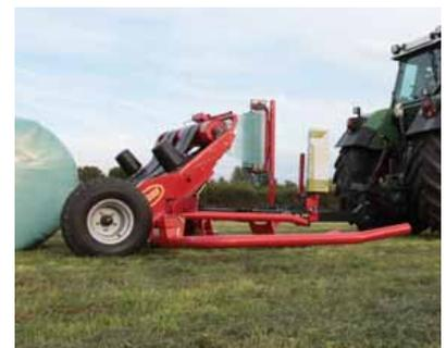
Eine niedrige Maschinenhöhe ermöglicht schnelles und schonendes Abladen der Ballen ohne Ablagematte.
