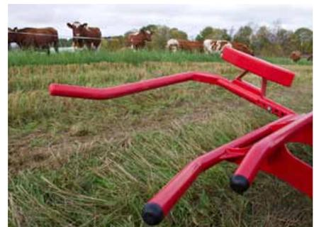
Der justierbare Ladearm mit einstellbarer Anschlagplatte ermöglicht eine schnelle Ballenaufnahme während der Fahrt.
