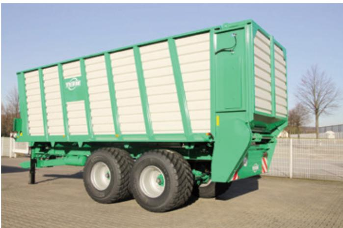
Silotrailer als Aufbaueinheiten für Tandemfahrgestelle mit 43 cbm Ladevolumen und bis zu 55 cbm Ladevolumen für Tridem-Fahrgestelle.
