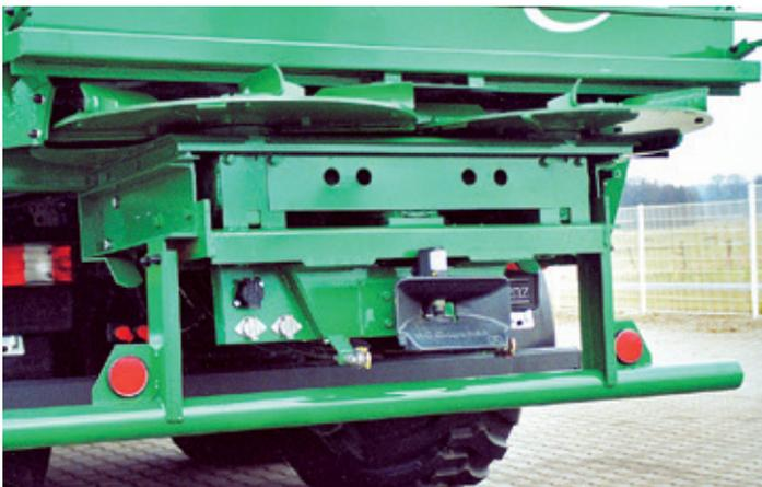
Die automatische Anhängerkupplung mit Brems- und Lichtanschlüssen sind bei Streuer-Aufbauten auf LKW optional. Durch die Kupplung kann der LKW ganzjährig als Zugmaschine eingesetzt werden.
