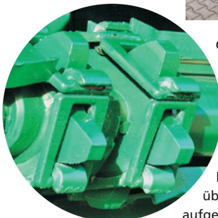
Geballte Zugkraft. Die Flachgliederketten Typ 100 HV und Typ 125 HV auf **TEBBE**-Streuern sind mit Abstand die stärksten Rollbodenketten, die überhaupt auf Streuern aufgebaut werden.
