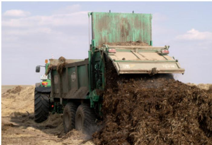
Mit allen **TEBBE**-Streuern kann Stallung oder Kompost in Mieten aufgesetzt werden. Der komplette Streutisch kann einfach und schnell demontiert werden.
