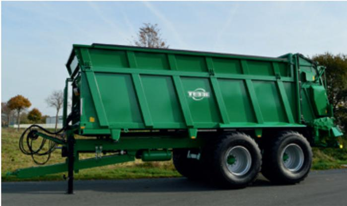
Der HS 220 als Wechselsystem mit 1400 mm hohem vollverschweißtem Stahlaufbau.
