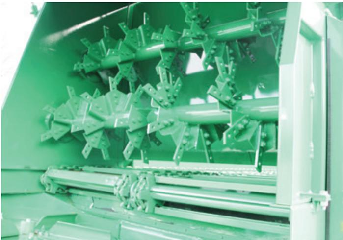
Der Fräsrollenantrieb erfolgt über eine verstärkte 1" Rollenkette. Der massive Kettenspanner kann bei geschlossenem Schutzkasten kontrolliert und nachgespannt werden.
