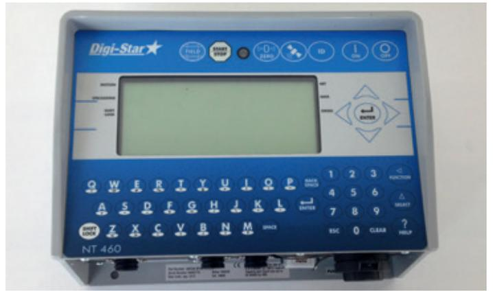
Die elektronische Wiegeeinrichtung kann mit Datenspeicher und Drucker ausgestattet werden. Ein USB-Anschluss ist vorhanden.
