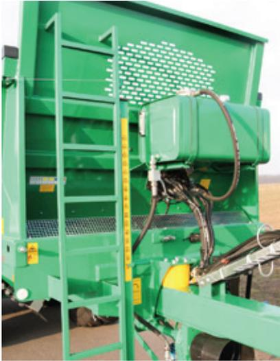
**TEBBE**-Streuer mit Bordhydraulik in Verbindung mit einer elektrischen Bedienung. Die Hydraulikpumpe ist direkt in die Antriebswelle im Fahrzeugrahmen eingesetzt.
