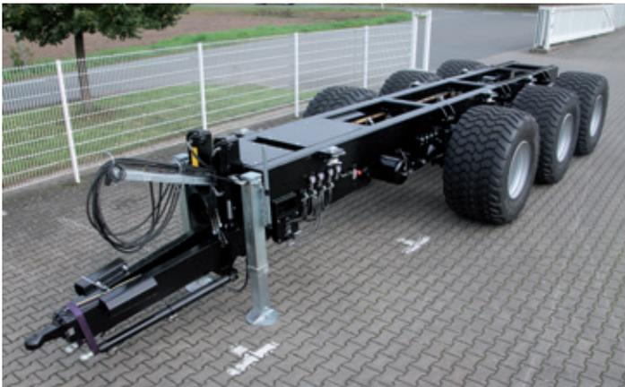
Tandem-Streuer mit Buggy-Fahrwerk oder Tridem-Streuer mit hydraulischer Federung haben Achsen, Federn, hydr. Zylinder und Aufhängung nur original von BPW. Dadurch hat der Kunde im In- und Ausland eine kompetente Ersatzteilversorgung.
