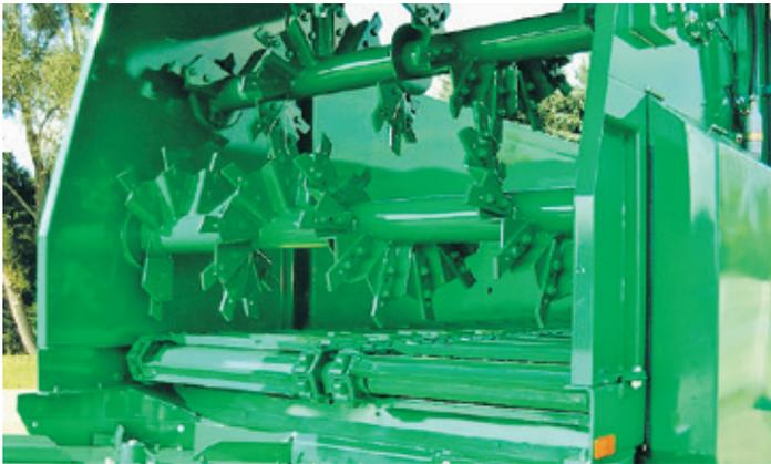
Aggressive Reißwalzen mit angeschraubten, legierten und gehärteten Verschleißspitzen garantieren bei hoher Durchsatzleistung eine optimale Zerkleinerung. Im DLG Test Nr. 4969 war der **TEBBE**-Streuer der einzige Streuer, der bei **35 m Streubreite** einen VK < 30 % erreichte.
