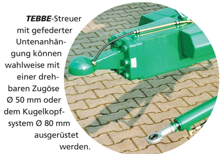
**TEBBE**-Streuer mit gefederter Untenanhängung können wahlweise mit einer drehbaren Zugöse Ø 50 mm oder dem Kugelkopfsystem Ø 80 mm ausgerüstet werden.
