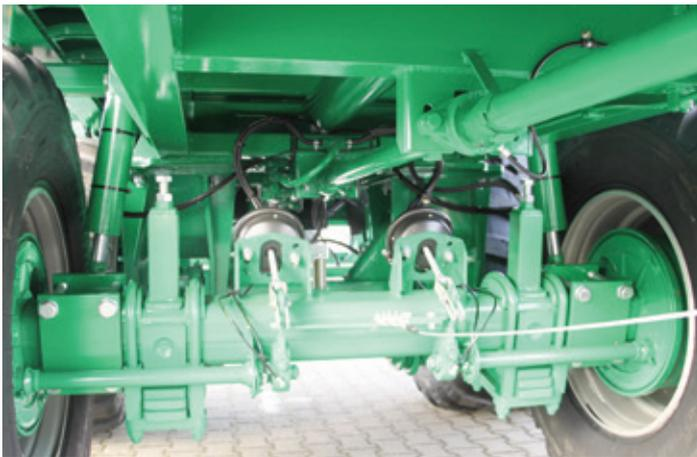
Durch das Anheben der hydr. Liftachse erhöht man während des Streuens die Stützlast um ca. 1000 kg.
