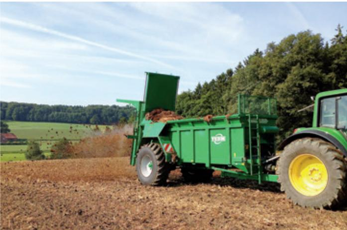
Die TS-Streuer können beim Ausbringen von Stalldung mit 7 PS pro cbm Zuladung gefahren werden. Alle Streuer der TS-Baureihe haben ein Streuwerk mit zwei vertikalen Streuwalzen.
