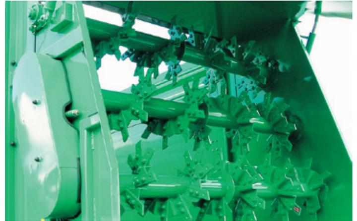
Das Streuwerk mit drei Fräsrollen ist für besonders große Streumengen pro Hektar ausgelegt. Bei drei Fräsrollen ist Streuwerkhöhe und max. Schieberöffnung jeweils 1900 mm hoch.
