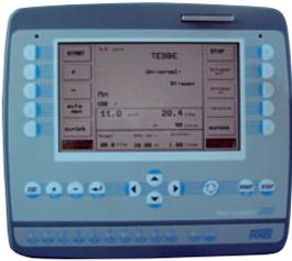
Elektrische Steuerung über Field operator 300 von WTK für geschwindigkeits- oder gewichtsabhängige Streumengenregulierung. Auf Wunsch in GPS Version.
