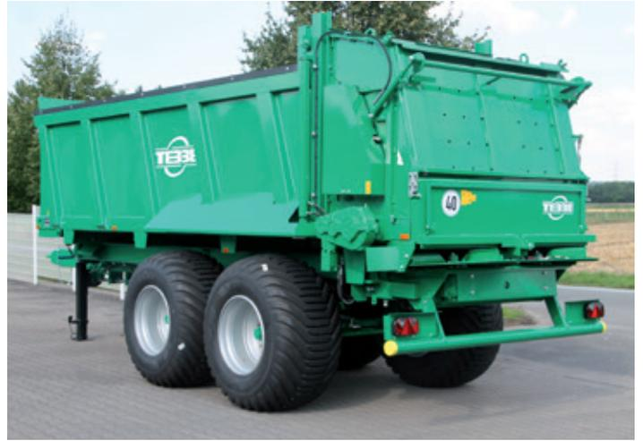
Die DS 140, DS 160 und DS 180 werden mit 120 – 150 PS Traktorleistung gefahren.
