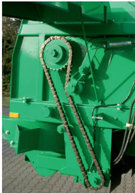
Der Fräsrollenantrieb erfolgt bei der MS-Baureihe serienmäßig über eine verstärkte 1 ¼" Kette.
