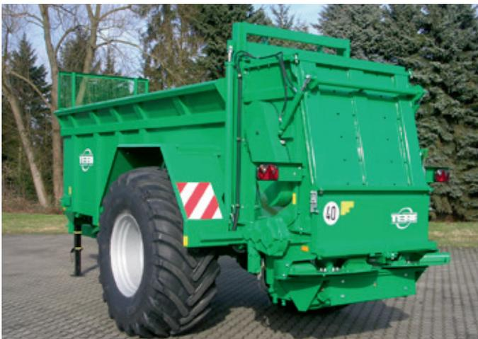
In der Serienausstattung wird die MS-Baureihe mit der Bereifung 650 / 65 R 38 ausgerüstet.
