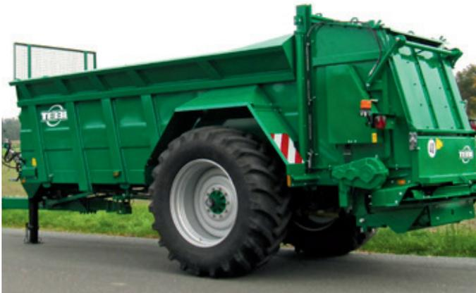
Auf Grund der selbsttragend konstruierten Streermulde ist kein Fahrgestell notwendig. Hierdurch wird das Eigengewicht des Streuers reduziert.
