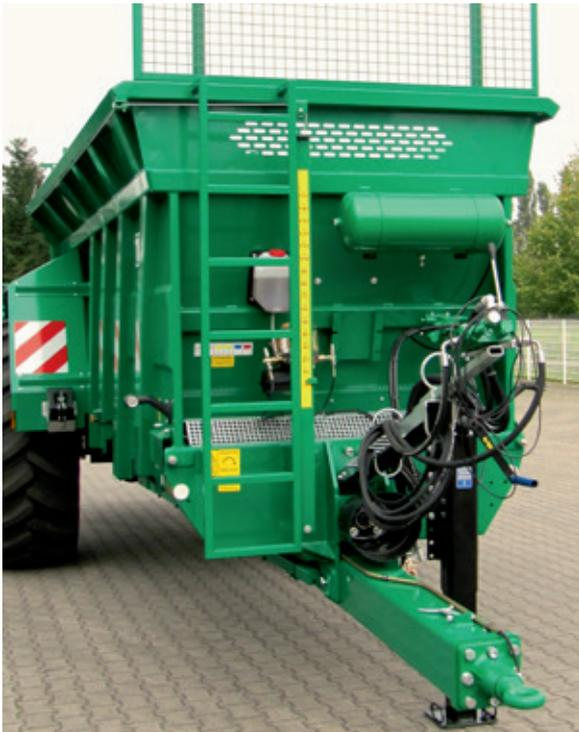
Der TEBBE MS 140 ist in der Grundausrüstung mit einer drehbaren Zugöse Ø 50 ausgestattet. Die Deichsel ist gefedert und dreifach höhenverstellbar.
