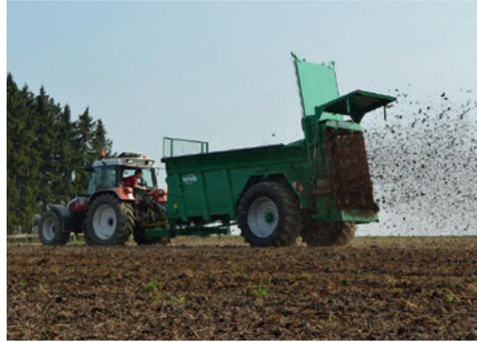
Der TS Tieflader hat ein Streuaggregat mit zwei vertikal angeordneten Streuwalzen.
