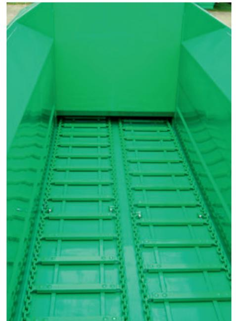
Rollboden in Serienausstattung: vier Rundstahlkettenstränge 14 x 50 mm ( 25 to Bruchlast je Kettenstrang) mit stabilen U-Profil-Leisten.
