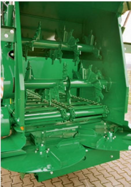
Die Fräsrollen sind mit beschichteten Anschraubspitzen aus hochfestem Stahl ausgestattet, die eine optimale Zerkleinerung garantieren.
