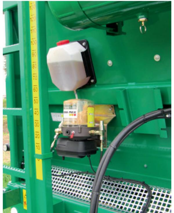
Optional können alle Streuer mit einer vollautomatischen Zentralschmierung ausgerüstet werden, die alle wesentlichen Schmierstellen mit der entsprechenden Fettmenge versorgt.
