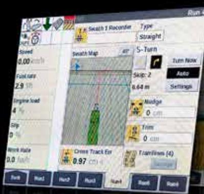
S-Turn wendet automatisch am Ende der Fahrspur
