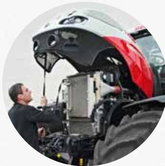
Einteilige gasdruckgefederte Motorhaube kann in zwei Positionen angehoben werden (45°/90°), sogar mit angebaubem Frontanbaugerät.
