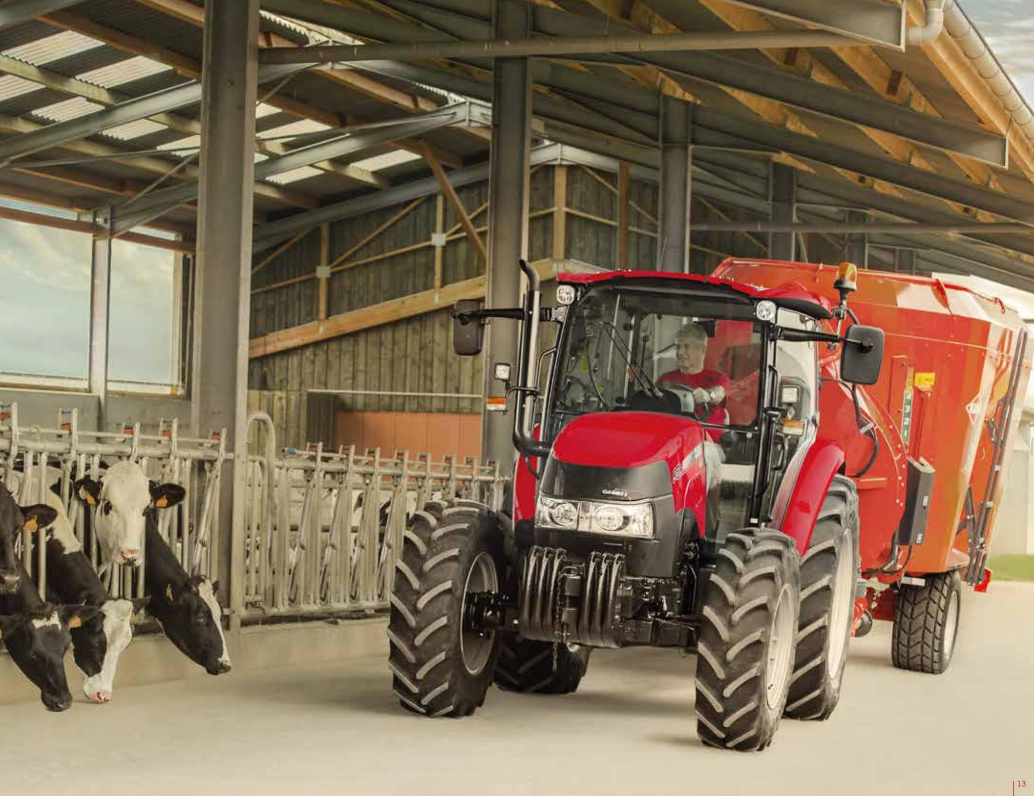
Mit dem elektronischen Fronthubwerk (EFH) kann der vordere Anbauraum optimal genutzt werden. Das System hebt bzw. senkt das Anbaugerät automatisch auf die vorgegebene Höhe und hält den Auflagedruck konstant. Damit lassen sich Frontmäherwerk, Frontpacker und viele andere Geräte leichter und präziser steuern.
