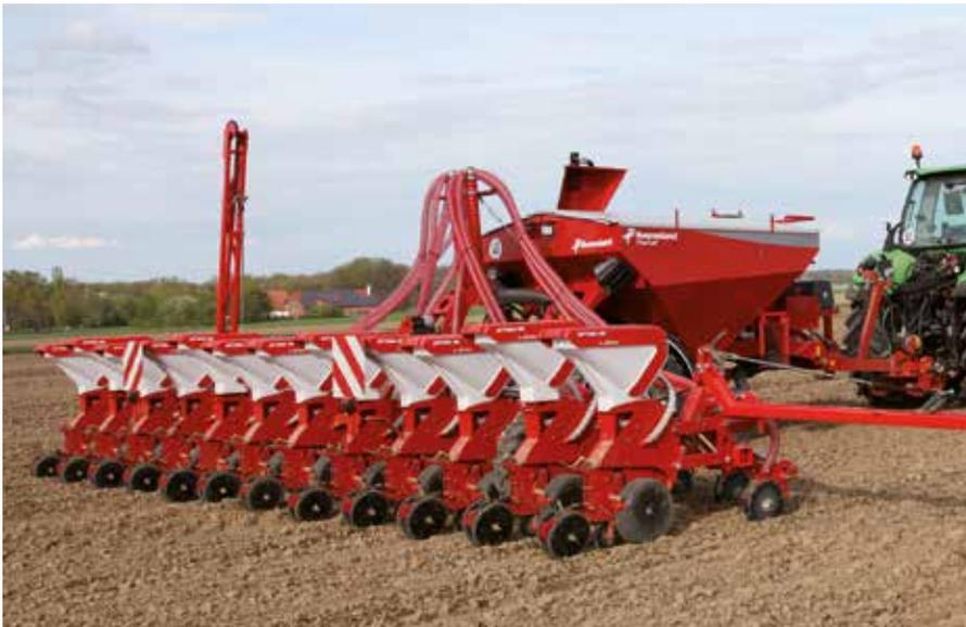
OPTIMA 9,00 m hydraulisch klappbarer Rahmen in Kombination mit FlexCart
