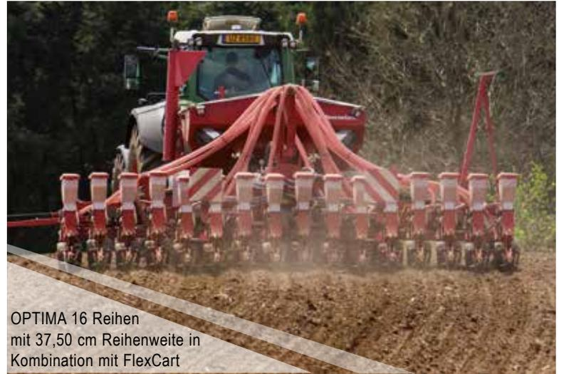
OPTIMA 16 Reihen mit 37,50 cm Reihenweite in Kombination mit FlexCart
