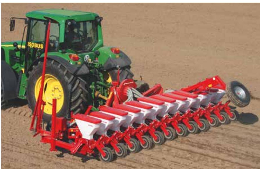
OPTIMA 12 Reihen mit 6,10 m Arbeitsbreite und Langfahrvorrichtung
