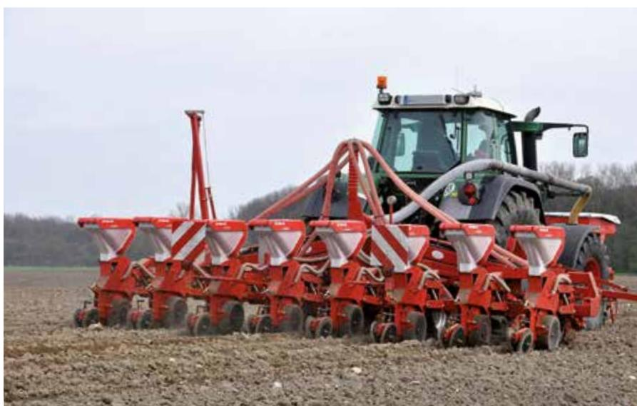
OPTIMA 6,00 m hydraulisch klappbarer Rahmen
