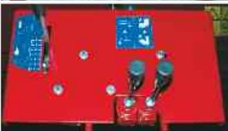
Alle Funktionen lassen sich von der Schlepperkabine aus bedienen. Deutliche Symbole geben die Funktion jedes Hebels an.
