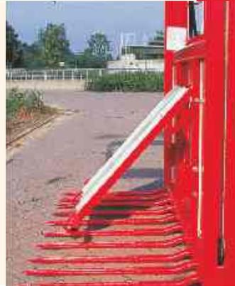
*Der mechanische Abschiebevorrichtung hat eine große Reichweite, sodaß der Block ganz von den Gabelzinken abgesetzt werden kann.*
