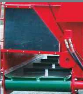
Das breite hydraulisch angetriebene Querförderband hat eine Dosierhöhe von 0.60 m.
