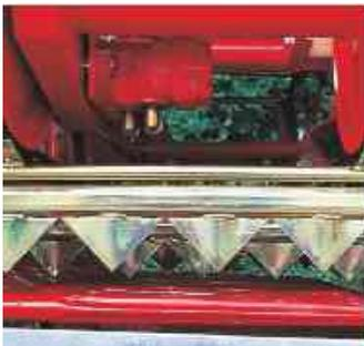
*Der Verteiler kommt sehr nah an die Gabelzinken heran, sodaß der Block völlig, bis auf die letzten Reste verteilt wird.*
