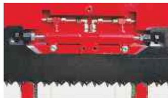
*Extra Schneidkraft durch zwei separat angetriebene und vernünftig integrierte Sägezylinder.*
