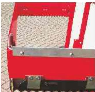
*Der Schneidrahmen ist sehr schlank konstruiert, sodaß ein minimaler Schnittwiderstand entsteht.*
