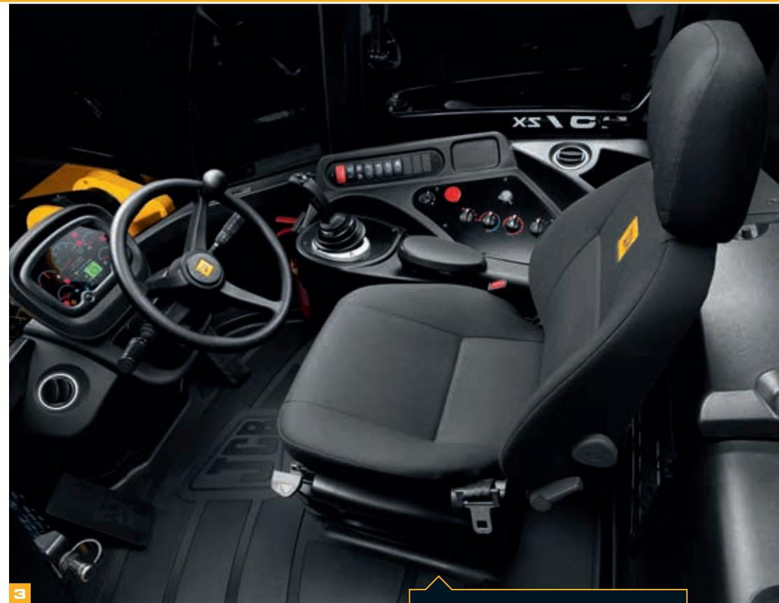
Der Sitz ist in mehreren Ausführungen erhältlich: mechanisch oder luftgedert, Vinyl- oder Textilsitzflächen oder sogar unsere Actimo XXL-Option. Diese bietet Sitzheizung, Luftfederung, Lendenstütze, Armlehnen, hochgezogene Rückenlehne und Kopfstütze, sämtlich voll verstellbar.
