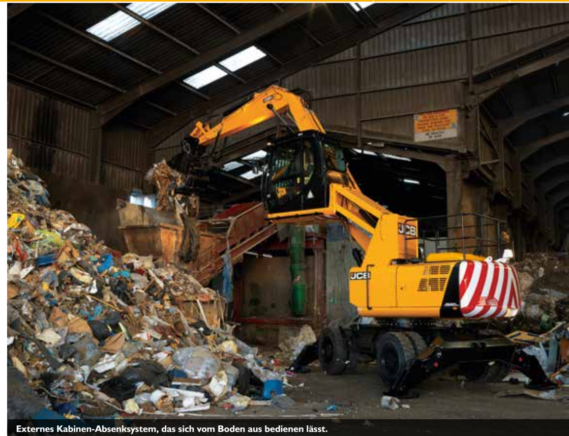
Externes Kabinen-Absensystem, das sich vom Boden aus bedienen lässt.
