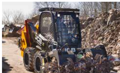
Unübertroffene Sicht nach beiden Seiten dank Ausleger mit niedrigem Anlenkpunkt.
