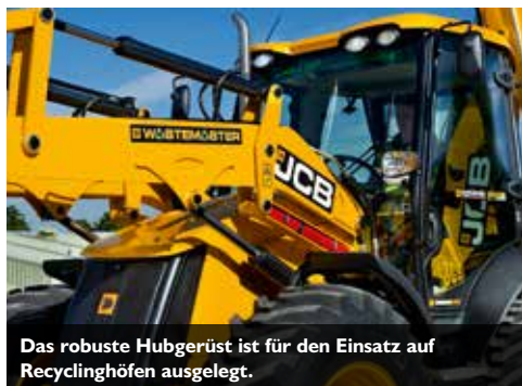
Am Hubgerüst lassen sich andere Anbaugeräte anbringen, um verschüttetes Material schnell und einfach aufzunehmen.
