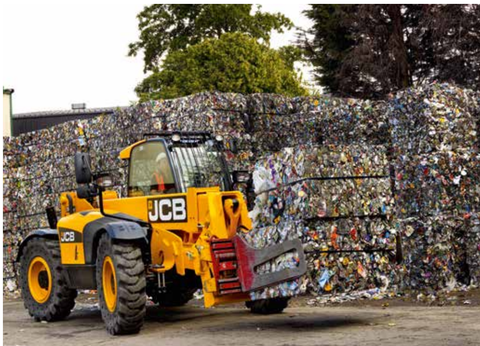
Flache Motorhaube und flacher Ausleger für freie Sicht zur Seite.
