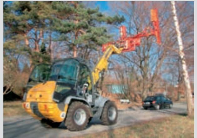
Ast- und Wallheckenscheren, kpl. mit Frontladerverschiebearm für die Frontladeraufnahme nach Euro-Norm, einschließlich hydraulischer und elektro-hydraulischer Steuerung, rechtsarbeitend. Verschiebung um 1,60 m, Ausweichvorrichtung
