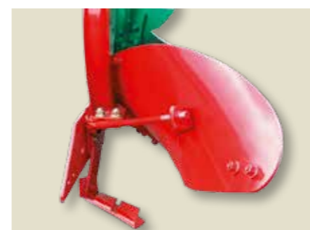
Ökoschar Ein Spezialschar, um die Pflugtiefe insgesamt um wenigstens 10 cm zu reduzieren, dabei aber gleichzeitig auf einem Drittel der Arbeitsbreite die alte Pflugtiefe beizubehalten.
