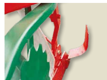
Kantenbrecher Ist am letzten Körper erforderlich, wenn die Schlepperbereifung wesentlich breiter als die Schnittbreite der Körper ist.
