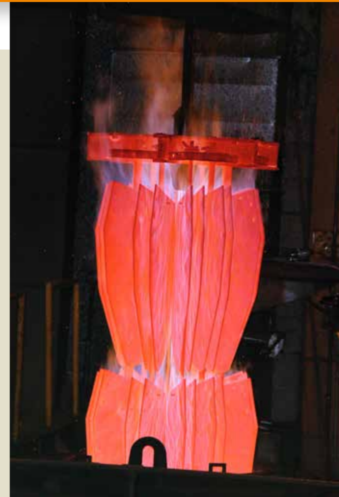
12-stündige Wärmebehandlung der Streichbleche
