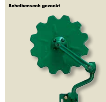
Scheibenseche Scheibenseche sorgen für eine saubere letzte Furche. Sie sind mit einem Durchmesser von 45, 50 und 55 cm glatt (gewellt) oder gezackt lieferbar. Sie können horizontal und vertikal angepasst werden.
