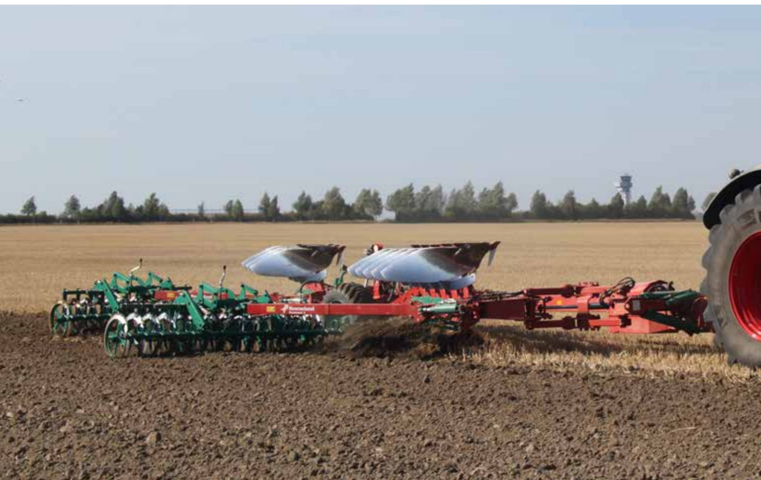
Kverneland PW 100 Variomat® On-Land mit Packomat – Pflügen und Rückverfestigung in einem Arbeitsgang
