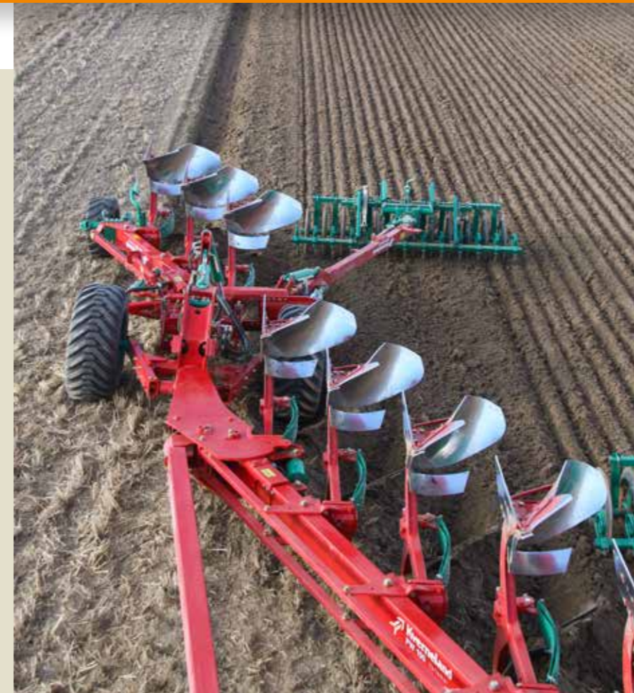
Tiefgründige streifenweise Rückverfestigung
