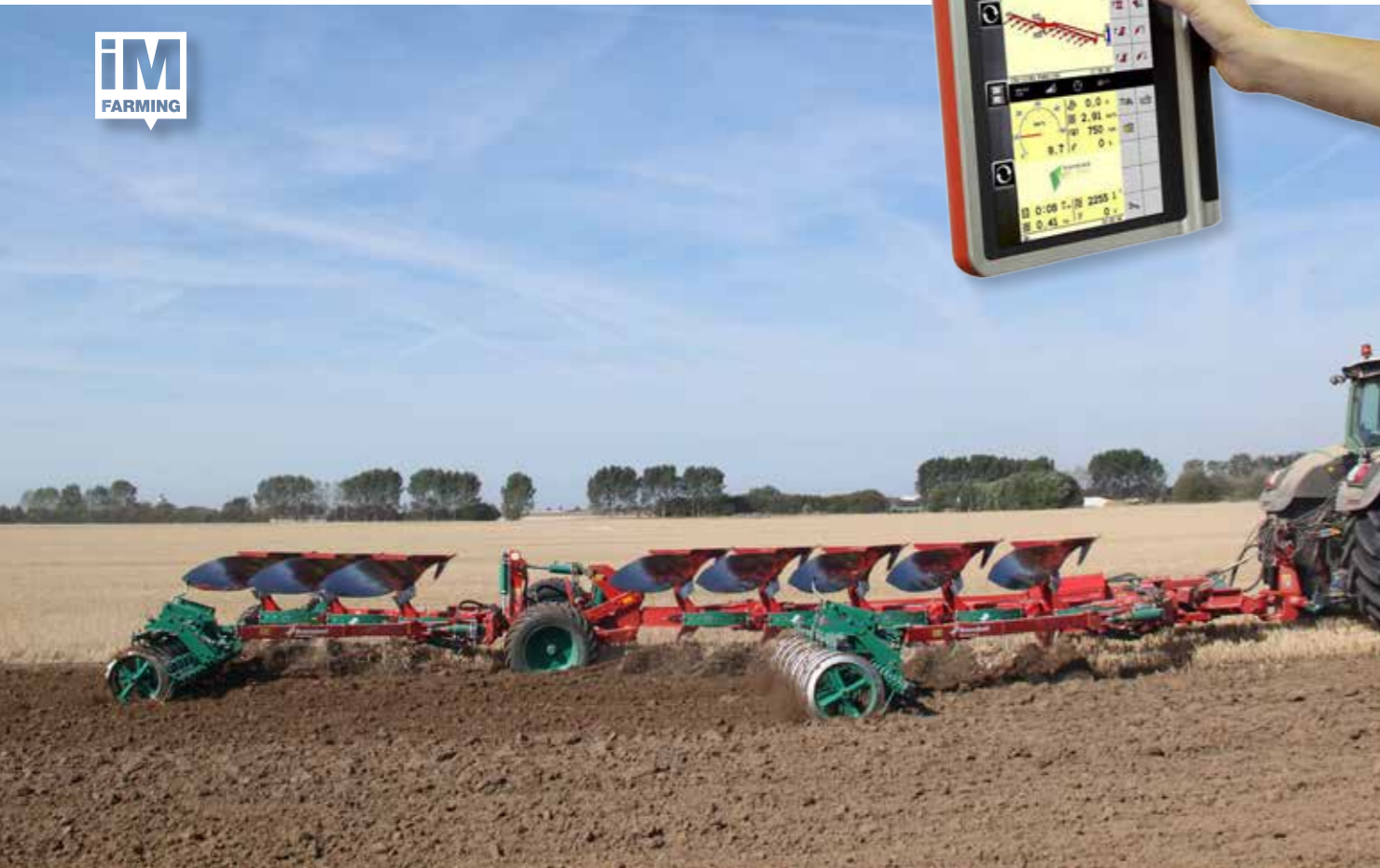
Kverneland PW 100 Variomat® mit Packomat – ISOBUS vereinfacht die Bedienung
