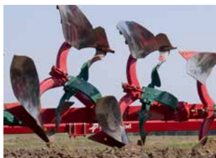
Blattfedersteinsicherung ■ 640 bis 1.400 kg Auslösedruck ■ Modelle: PN/PG/PB/PW
