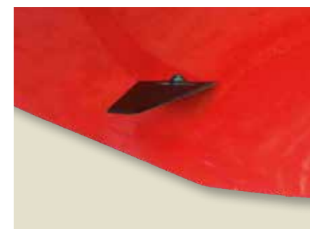
Furchentrenner Einfach im Streichblech oder Schar verschraubt, ermöglicht der Furchentrenner ein Aufschneiden des gewendeten Erdbalkens. Durch den Schnitt kann der Boden besser krümeln.
