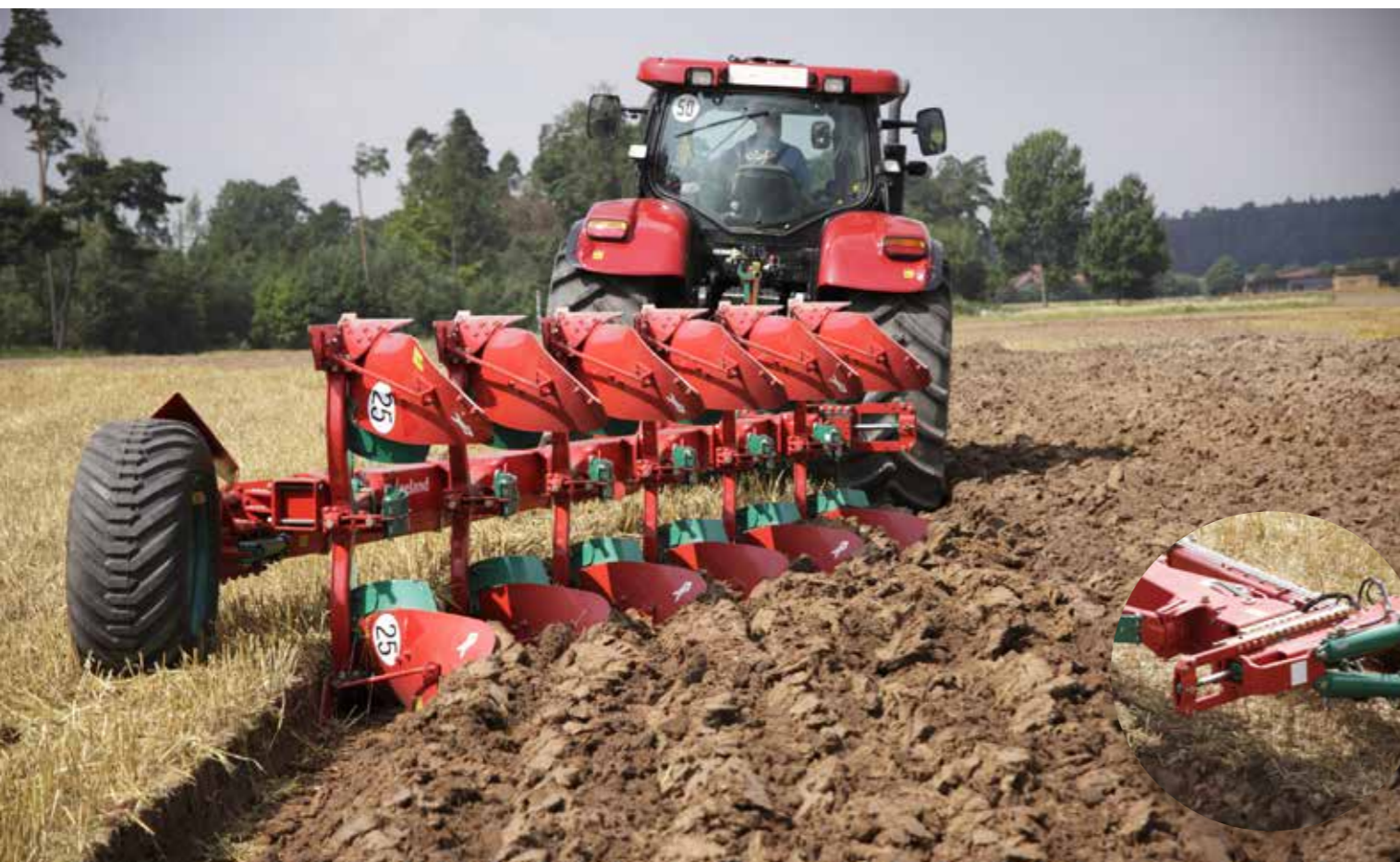
Kverneland PB 100 Variomat® | Detail: Drehwerk mit Schlitten zur Vorderfurchenanpassung
