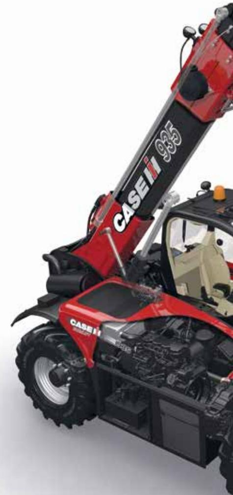
Die Kombination aus Ausgleichszylinder und Kippzylinder gewährleistet eine erhöhte Standsicherheit und ermöglicht die ruckfreie Führung des Teleskoparms. Gemeinsam sorgen die Zylinder da-
