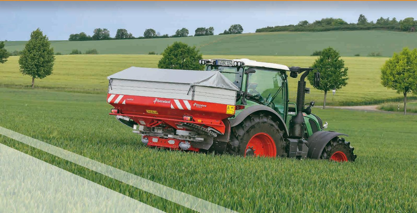
**Der Exacta HL ist das größte Modell der Exacta Baureihe. Dieser Streuer ist sehr robust und das maximale Behältervolumen beträgt mit 3 Aufsatzrädern 3.900 Liter.**
