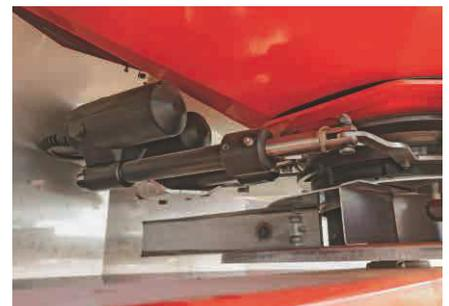
Zwei Stellmotoren an jedem Dosiersystem steuern den Aufgabepunkt und die Dosiermenge
