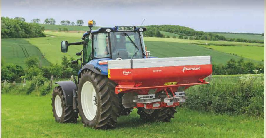
Grenzstreuen unter Verwendung der Grenzstreuplatte (manuell oder hydraulische Version verfügbar)
