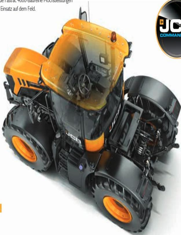
Die selbstnivellierende Volfederung hält Ausleger und Tanks auf gleichbleibender Höhe.
