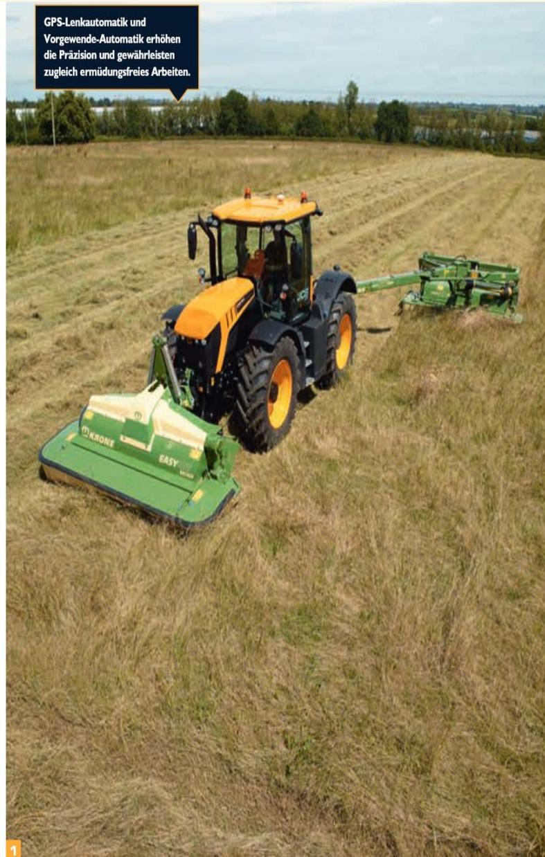
Die einzigartige seitliche Nivellierung sorgt für maximale Stabilität und Produktivität sowie höchsten Fahrerkomfort, besonders in schwierigem Gelände.
