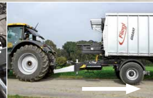
Hydraulische Sattelplattenverschiebung für Einachs- und Tandem-Dolly
