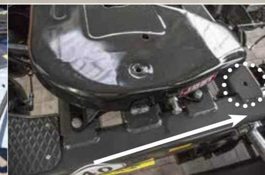
Mechanische Sattelplattenverstellung für Einachs- und Tandem-Dolly
