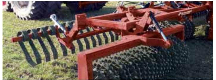
Ausgestattet mit einem Clod Board ist die Actiroll HDC ein universelles Gerät zur Saatbettbereitung. Da jede Sektion mittig aufgehängt ist, folgt die Walze allen Bodenkonturen und gewährleistet somit eine gleichmäßige Einebnung und Rückverfestigung.
