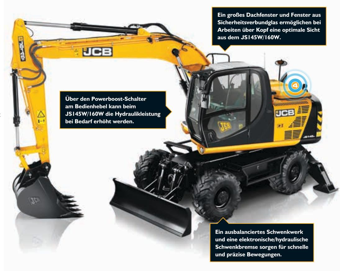
Ein großes Dachfenster und Fenster aus Sicherheitsverbundglas ermöglichen bei Arbeiten über Kopf eine optimale Sicht aus dem JS145W/160W.
