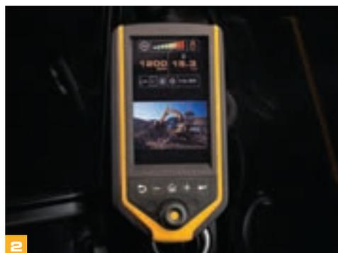
**3** Die Sicherungssperre von JCB deaktiviert die hydraulischen Funktionen vollständig, um unbeabsichtigte Bewegungen der Maschine zu vermeiden. Durch das „2 Go“-System von JCB wird über zwei separate Eingaben die Bedienung wieder aktiviert.
