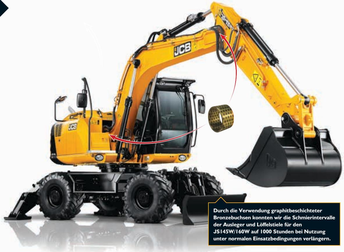
Durch die Verwendung graphitbeschichteter Bronzebuchsen konnten wir die Schmierintervalle der Ausleger und Löffelstiele für den JSI45W/160W auf 1000 Stunden bei Nutzung unter normalen Einsatzbedingungen verlängern.
