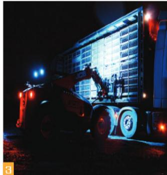
**3** Da Geflügel unter Umständen empfindlich auf bestimmte Lichtquellen reagiert, enthält das Poultrymaster-Paket blaue LED-Arbeitscheinwerfer für Front und Heck.
