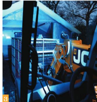
**4** Die Wendigkeit dieses Agri Teleskopladers ist einmalig. In den beengten Verhältnissen von Geflügelstallungen werden Sie die Allradlenkung und den großen Lenkeinschlag besonders schätzen lernen.
