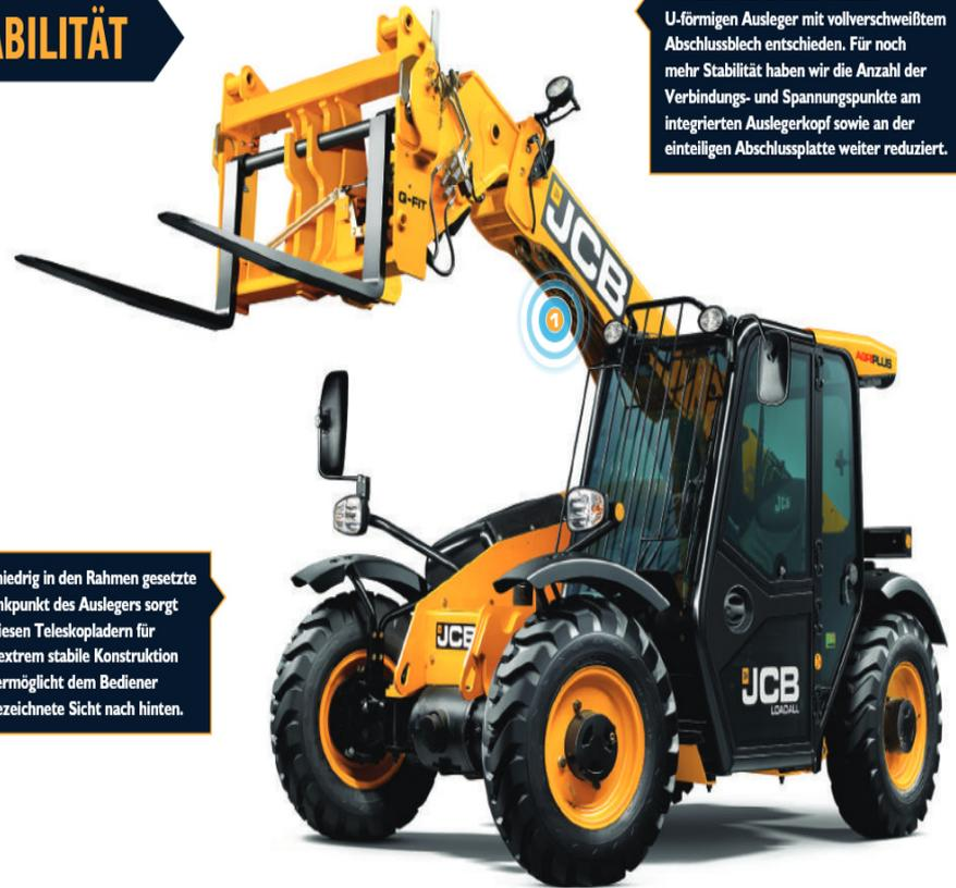
Der niedrig in den Rahmen gesetzte Anlenkpunkt des Auslegers sorgt bei diesen Teleskopladern für eine extrem stabile Konstruktion und ermöglicht dem Bediener ausgezeichnete Sicht nach hinten.
