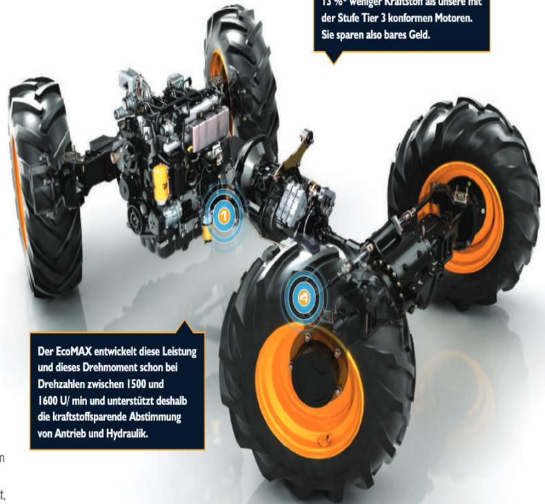
Der EcoMAX entwickelt diese Leistung und dieses Drehmoment schon bei Drehzahlen zwischen 1500 und 1600 U/ min und unterstützt deshalb die kraftstoffsparende Abstimmung von Antrieb und Hydraulik.
