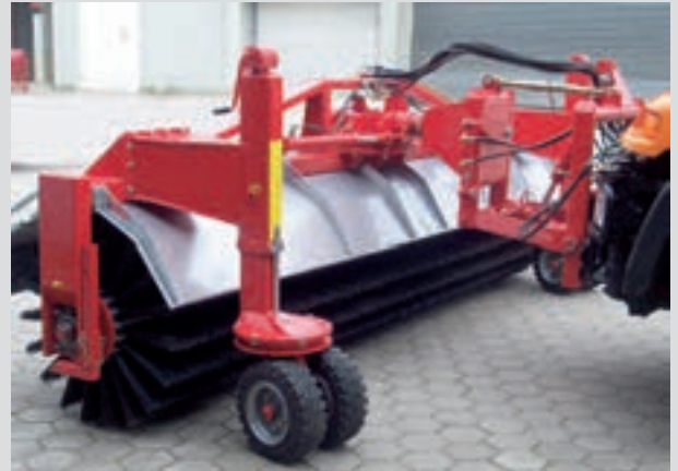
Bodenanpassung über höhenverstellbare Räder
