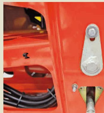
Hydraulische Verriegelung Pendelsystem
