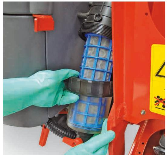
Die Saugfilter sind einfach zu kontrollieren und zu reinigen
