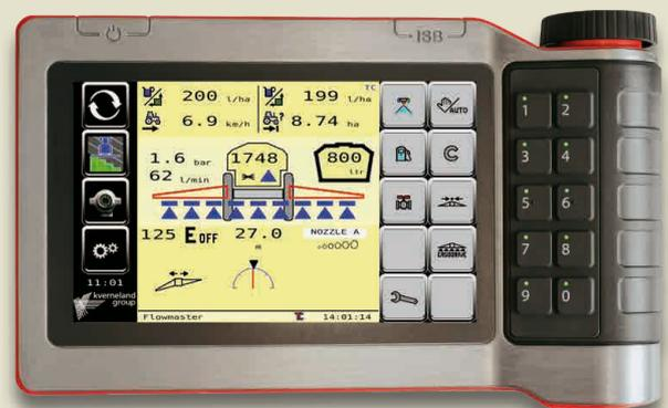
Das IsoMatch Tellus GO kann in Kombination mit der Switchbox eingesetzt werden, um alle Spritz-, Hydraulik- und Gestängefunktionen zu steuern. Für eine noch komfortablere Bedienung kann zusätzlich der IsoMatch Grip angeschlossen werden.
