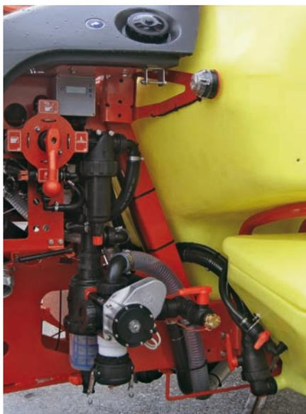
Selbstreinigender Druckfilter, durchsichtiger Saugfilter oder Füllstandsanzeige, hier laufen Funktionssicherheit, einfache Kontrolle und Bedienungsfreundlichkeit zusammen. Die Tür schützt vor Verschmutzung oder bietet schnellen und direkten Zugriff. Servicefreundlichkeit ist hier neu definiert. Einfache Kontrollmöglichkeiten und gute Zugänglichkeit der Baugruppen.
