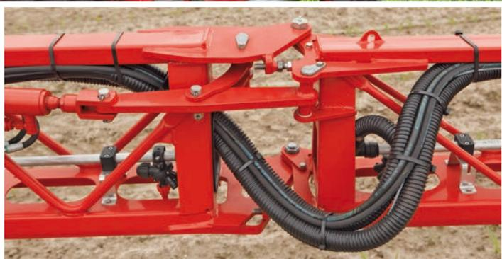
Die Zylinder sind in Arbeitsstellung eingefahren, also kurz und stark.
