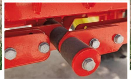
Das Design des Gestänges vereint geringes Gewicht mit maximaler Stabilität. Spritzleitungen und Düsen sind zu 100% geschützt im Gestänge.
