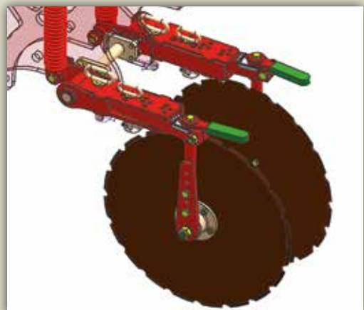
Die Seitenscheiben halten die Erde im Streifen und definieren seine Breite. Sie können in unterschiedliche Positionen gestellt werden und ihr Winkel ist einstellbar.
