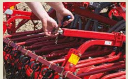
Abhängig von den Bodenverhältnissen können Druck und Winkel der Striegel manuell eingestellt werden.
