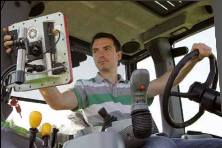
Der IsoMatch Tellus ist das erste ISOBUS Terminal weltweit, welches gesteigerte Hardwarekapazität mit zwei Displays in einem Gerät vereint. Er ermöglicht die komfortable Kontrolle zweier ISOBUS-Geräte ohne zu blättern.
