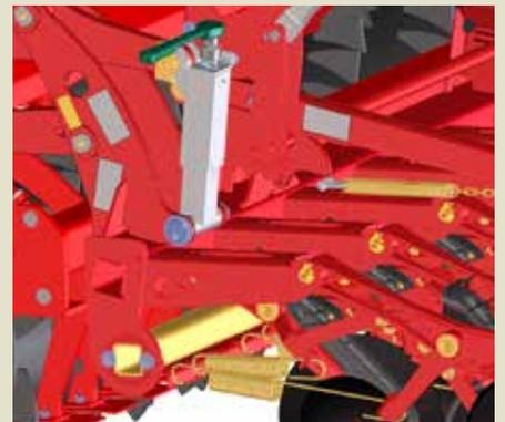
Die mechanische Sätiefeneinstellung mittels Spindel ist Standard. Sie kann über Spindeln eingestellt werden. Die Scharschiene kann zu dem ausgehoben werden.
