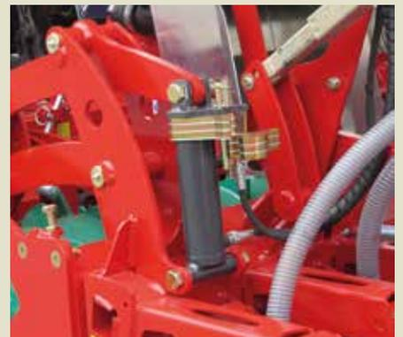
Die zentrale Sätiefeneinstellung mittels Spacer (Option) befindet sich an den zwei außen positionierten Hydraulikzylindern. Die Skala der Schardruckverstellung kann auch während der Fahrt abgelesen werden.
