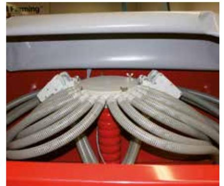
Im Tank liegender Verteilerkopf
