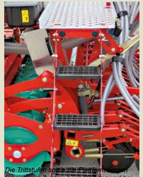
Die Trittstufen sowie die Plattform sorgen für sicheren Zugang beim Befüllen und bei Arbeiten am und im Tank.
