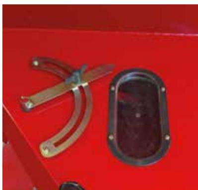
Der elektronische Füllstandssensor, der von außen einstellbar ist, eignet sich für geringe Mengen wie Raps, bis hin zu großen Ausbringmengen.
