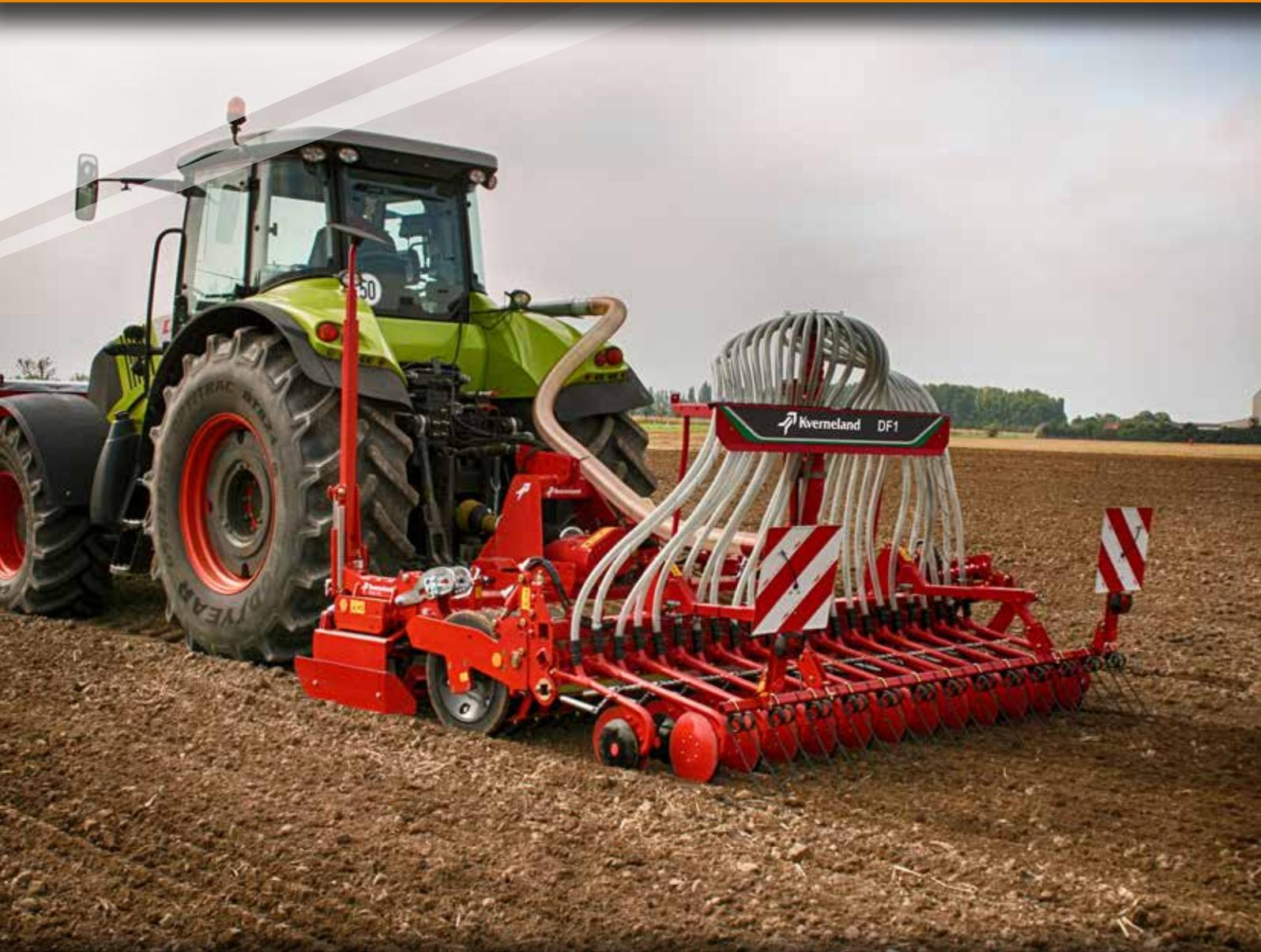
Die aufgelöste Bauweise führt bei der Kverneland DF-1 zu einer gleichmäßigen Gewichtsverteilung auf die Anbauräume und erreicht damit eine optimale Schlepperballastierung. Dies verbessert die Fahrsicherheit und Manövrierbarkeit und ermöglicht gleichzeitig dem Fahrer einen perfekten Überblick über das Gespann.
