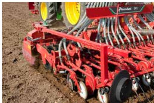
Die hydraulisch klappbaren Spuranreißer mit Überlastsicherung befinden sich direkt auf der Wanne der Kreisellege.
