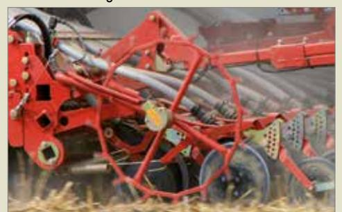
Spornrad mit integrierter Bremse
