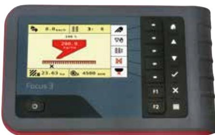
Focus 3 ist ein Terminal des e-bas- Systems, um alle Funktionen der Sämaschine zu steuern. Nicht ISOBUS-kompatibel.
