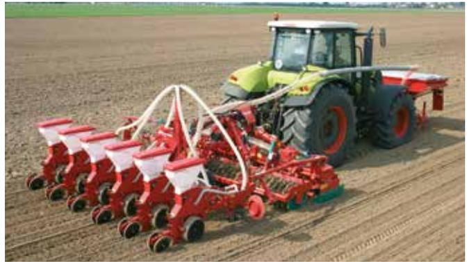
Der DF-1 Tank als Düngerbehälter bei der Einzelkornaussaat bis zu 8 Reihen
