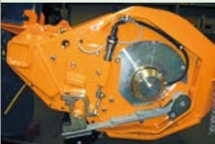
Vollautomatisch wirkende Auflagedruck-Regelung des Messerkopfes. Sensoren geben den Geländeverlauf an einen Zentralrechner. Dieser steuert die Auslegerfunktionen selbstständig.
