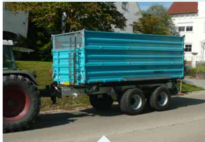
MEDK 16000 TA mit 2. Stahlpendelaufsatz.
