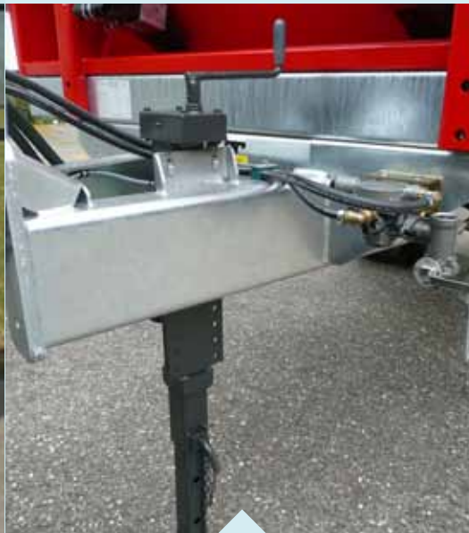
Stützfuß mit Untersetzungsgetriebe.
