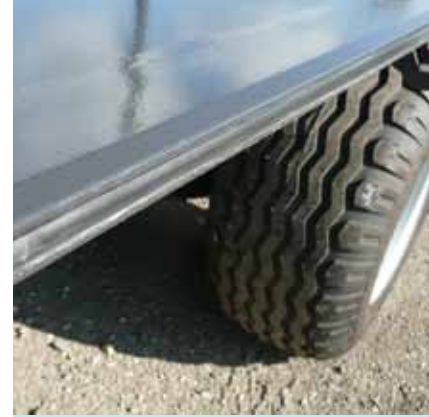
Rapsdichter Aufbau, selbstreinigende Brücke.
