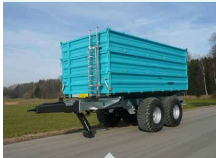
MEDK 18000 TA mit 2. Stahlpendelaufsatz und hydraulischer Rückwand.
