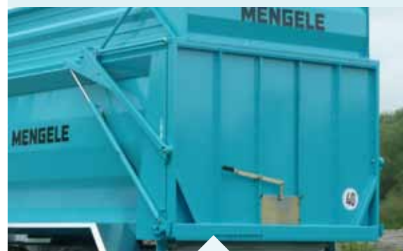
Hydraulische Rückwand mit Kornauslaufschieber.
