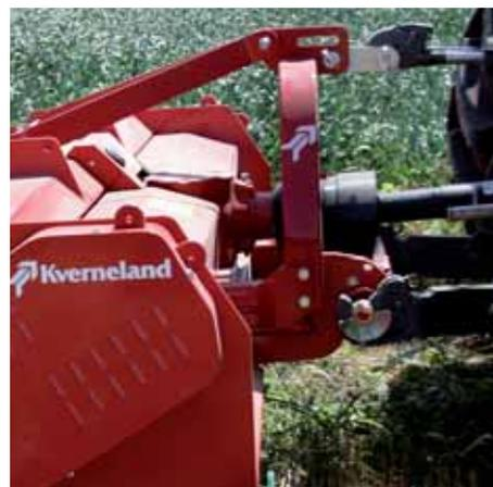
Die Halbautomatische Anhängung (Kat III) ermöglicht ein schnelles Ankuppeln des FXZ. Zusätzlich sorgt das Langloch im oberen Koppelpunkt für eine gleichmäßige Tiefenführung ohne zusätzliche Krafteinwirkung auf den Anbauturm.
