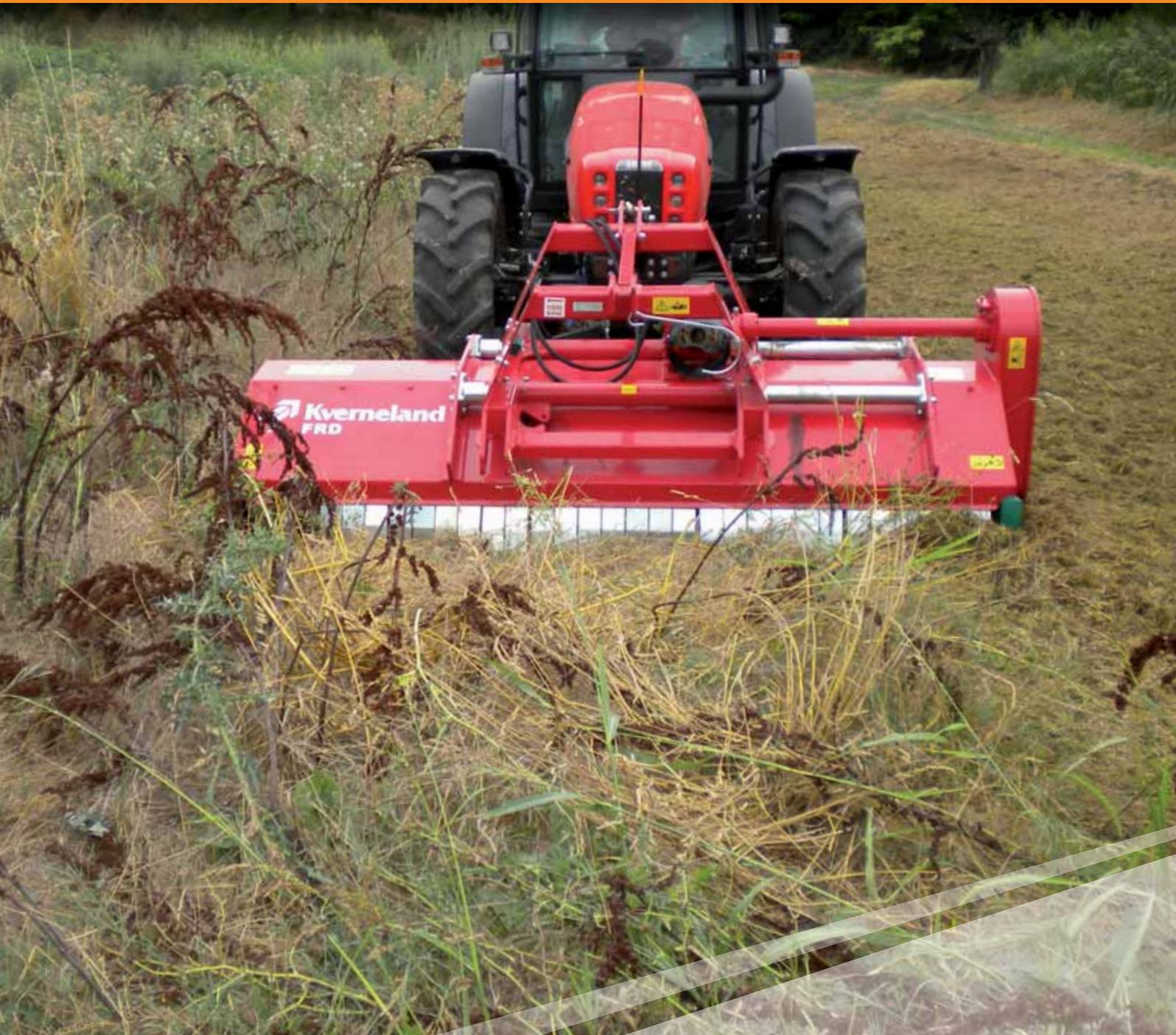
Der doppelte Anbaubock ermöglicht sowohl Front- als auch Heckanbau des FRD. Die serienmäßige hydraulische Verschiebung von bis zu 52 cm macht den FRD zu einem effizient und universell einsetzbaren Gerät. Die in den Anbaubock integrierten Gleitrohre der Seitenverschiebung sind mit verschleißarmen und wartungsfreien Kunststoffblöcken versehen, so dass auftretende Kräfte auf den Schlepper übertragen werden.
