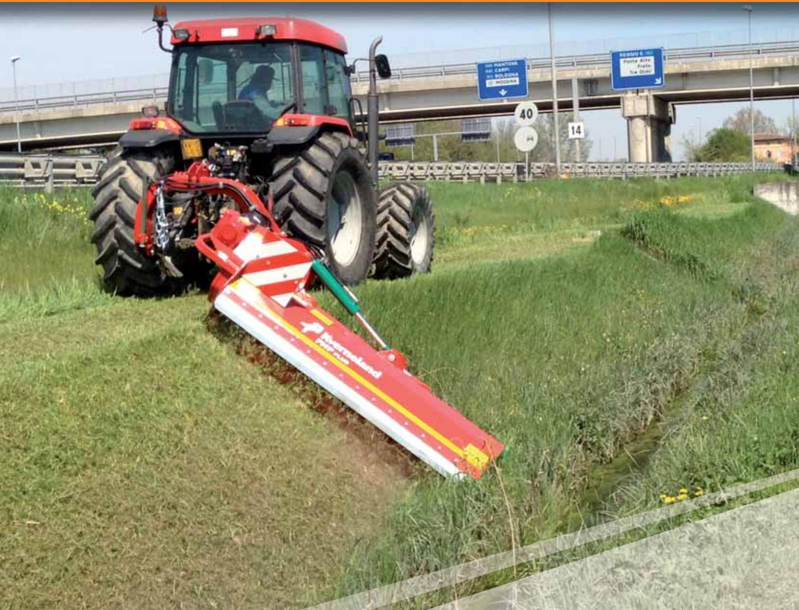
Der große Bruder des FHP überzeugt durch eine höhere, maximale Antriebsleistung (150 PS), durch Arbeitsbreiten von 200 und 230cm und die größere Seitenverschiebung von bis zu 1200 mm. Kombiniert mit einem Front Mulcher (Kverneland FRO oder FRD) stellt er eine flexible und leistungsstarke Einheit dar.
