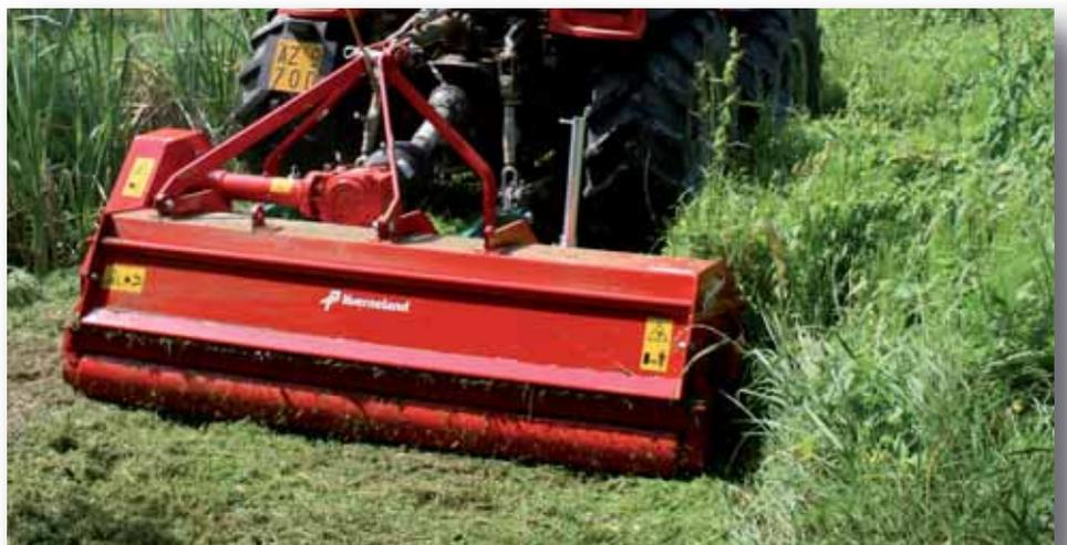
Das Herz des FM ist der Rotor: Hohe Umdrehungszahl (1993 U/min) in Verbindung mit der großen Auswahl an Schlegeln machen den FM einzigartig in seiner Klasse.
