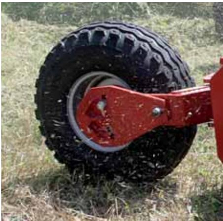
Schwenkbare Räder (10/8.0 x 12.8 ply) als Standardausrüstung sorgen für zusätzliche Stabilität und eine konstante Tiefenführung des FXZ.
