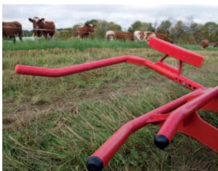
Der justierbare Ladearm mit einstellbarer Anschlagplatte ermöglicht eine schnelle Ballenaufnahme während der Fahrt.
