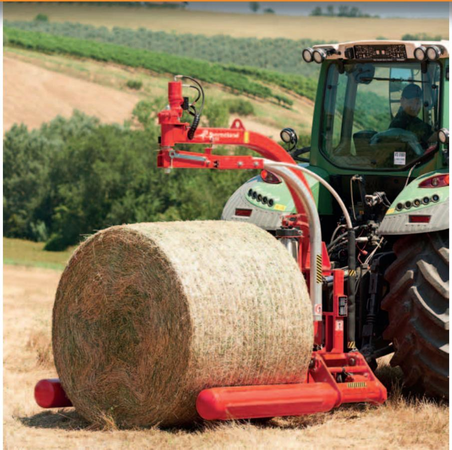
Der Kverneland 7820 C ist mit einer großen Stützrolle ausgestattet, die ein Wickeln während der Fahrt ermöglicht. Ballenwickeln während der Fahrt zum Lagerplatz oder zum nächsten Ballen ist kein Problem.
