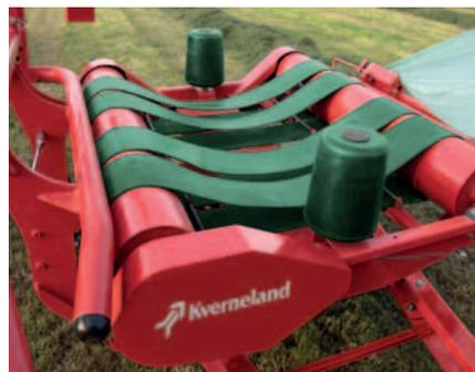
Der Drehtisch mit zwei angetriebenen Rollen ist für schwere Ballen und eine gleichmäßige Ballenrotation ausgelegt.
