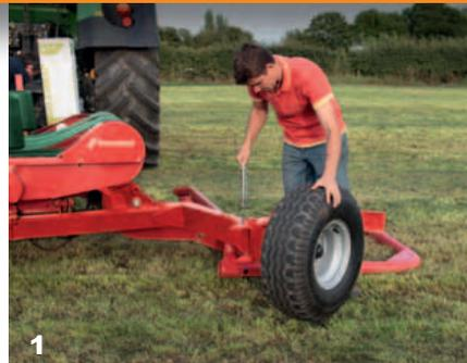
Zur Verringerung der Transportbreite wird das rechte Rad hydraulisch angehoben und einfach nach innen gedreht.
