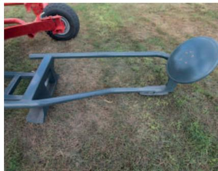
Am 7850 kann ein Ballendreher montiert werden, der die Ballen sanft auf die Stirnseite ablegt.
