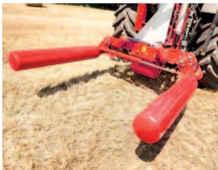
Schonende Ballenaufnahme, durch schwenkbare Walzen.
