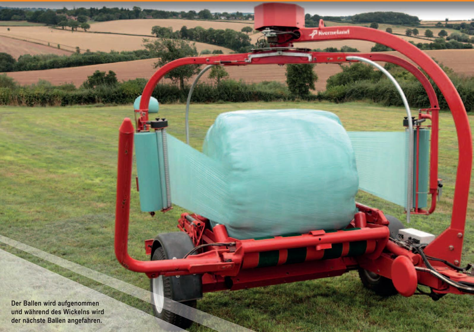
Der Ballen wird aufgenommen und während des Wickelns wird der nächste Ballen angefahren.
