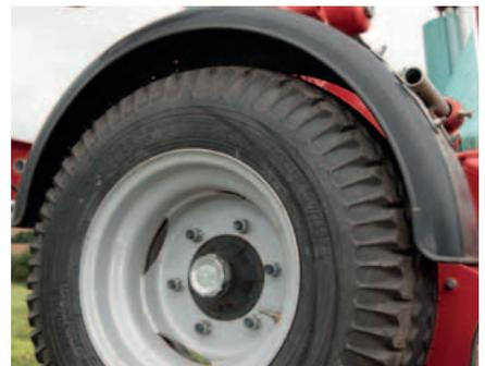
Die Kotflügel reduzieren die Verschmutzung an den Vorstreckern und Foliensrollen.
