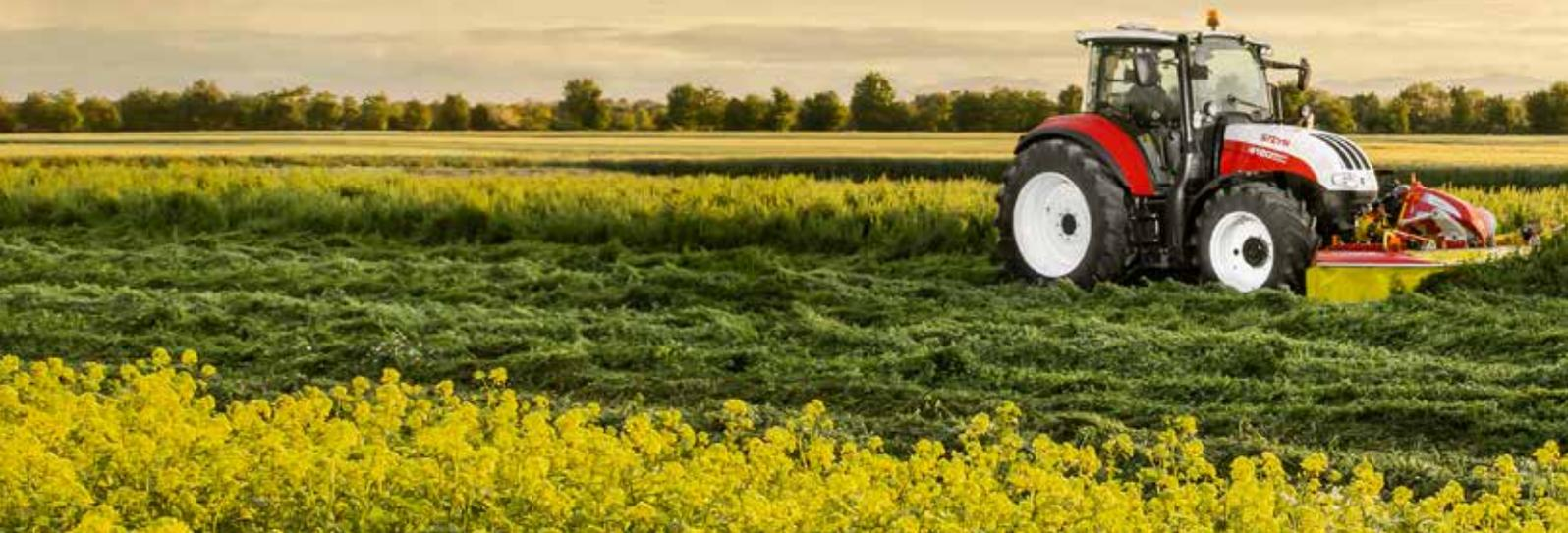
**STANDARD FRONTHUBWERK.** Das gesamte Gewicht des Frontmäherwerks liegt auf dessen Gleitplatten. Der hohe Druck auf den Boden vermindert die Gras- und Silagequalität und ist wenig bodenschonend.
