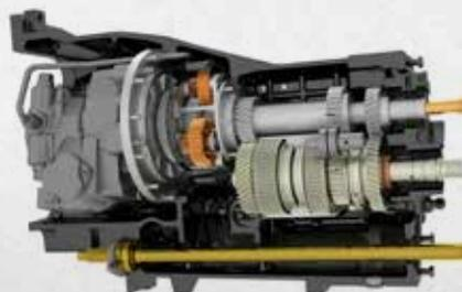
Stufenloses Getriebe von 0 bis 50 km/h
