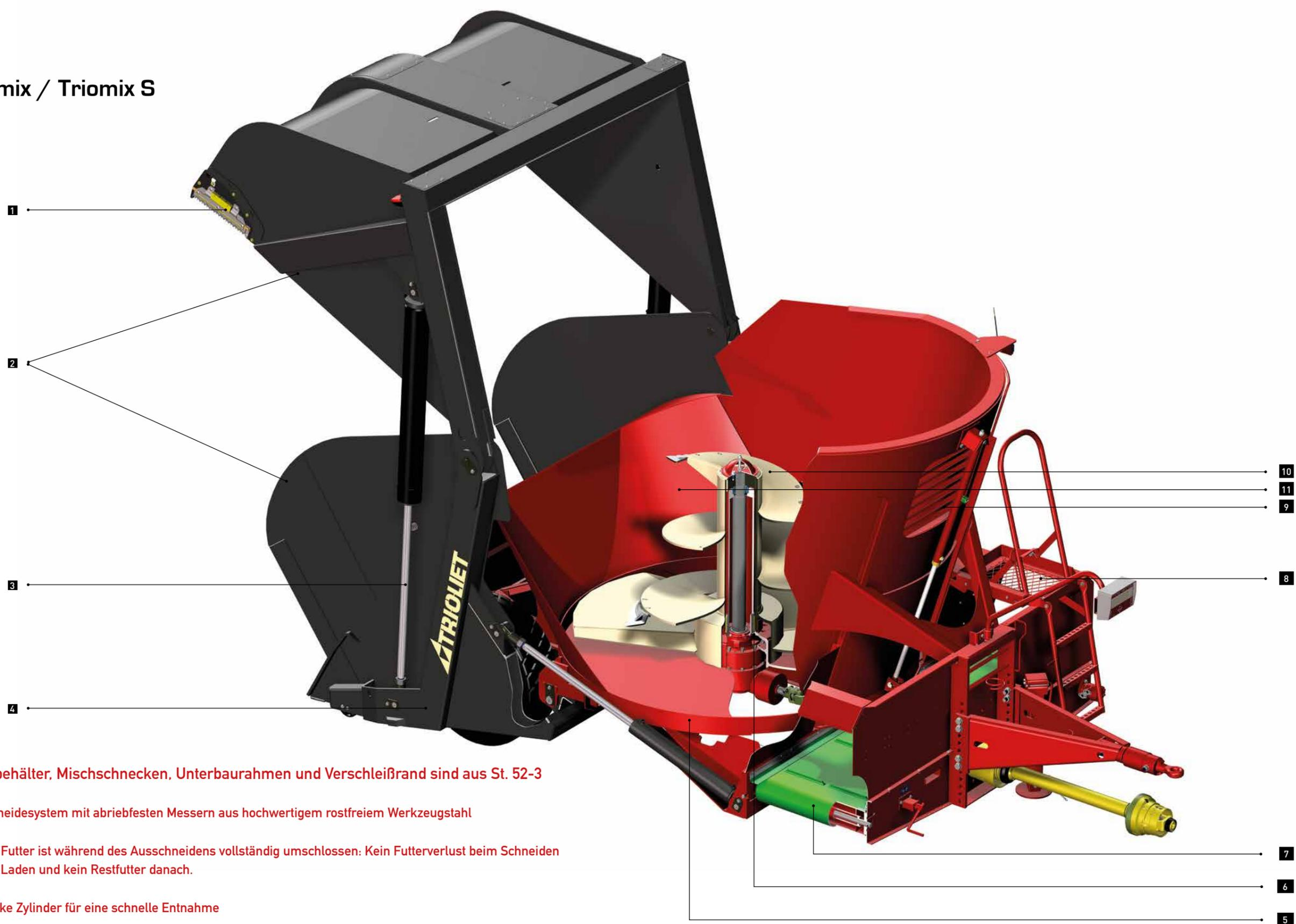
Mischbehälter, Mischschnecken, Unterbaurahmen und Verschleißband sind aus St. 52-3
