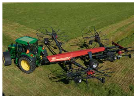
Der Einschlagwinkel bei Kurvenfahrten beträgt 80°.
