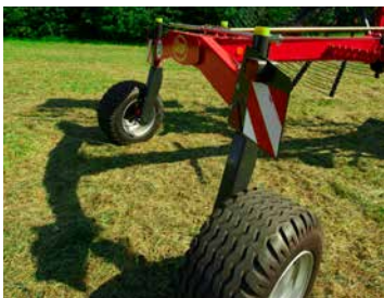
Das aktiv gesteuerte Fahrwerk sichert einen spurtreuen Nachlauf.
