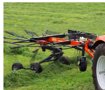
Der Andex 424 T hat eine Aushubhöhe von 50 cm.
