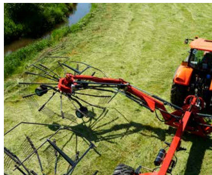
Die Arbeitsbreite lässt sich von 9,80 bis 15,00 m hydraulisch verstellen.
