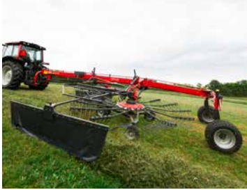
Ein hydraulisch klappbares Schwadtuch ist für den AnDEX 744 optional verfügbar.
