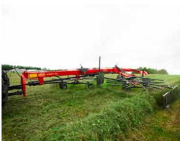
Der AnDEX 774 kann ein Schwad aus bis zu 15,00 m Arbeitsbreite ablegen.
