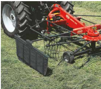
Index 353 besitzt eine Arbeitsbreite von 3,50 m und 10 abnehmbare Zinkenarme.
