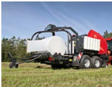
Doppelter Satellitenwickler mit zwei Vorstreckern und vier Endlosriemen für ein schnelles und stabiles Wickeln.
