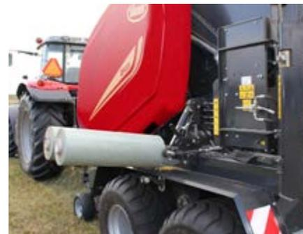
Hydraulisch schwenkbares Folienmagazin.
