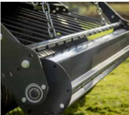
Der Rollenniederhalter sorgt für eine Vorverdichtung des Erntegutes und unterstützt den Materialfluss.
