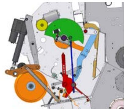
Während des Wickelvorgangs schwenkt der Zuführarm wieder in Wartestellung. Nach Erreichen der vorgewählten Netzwicklungen wird das Messer aktiviert und das Netz abgeschnitten.
