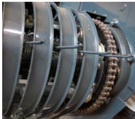
Patentierter, innenliegender Pickup-Antrieb für eine schmale Transportbreite.
