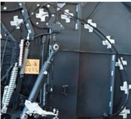
Leichte Wartung aller Walzenlager über zentrale Schmierleisten.
