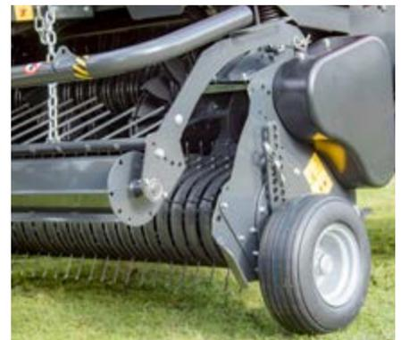
Die leicht in der Höhe verstellbaren Pickup-Tasträder sind luftbereit. Durch den innenliegenden Pickup-Antrieb müssen die Tasträder für die Straßenfahrt nicht demontiert werden.
