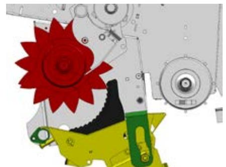
Schneidwerksboden in vollständig abgesenkter Position.
